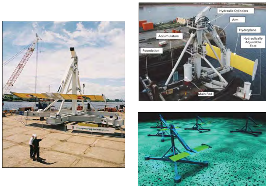
FIGURE 1.11 – Stingray , prototype d'aile oscillante semi-active à échelle réelle développé par Engineering Business Limited (Stingray, 2002) et testé dans les îles Schetland.
