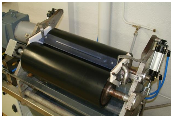
Figure 119. Photo d'une size press. Vitesse : 10m/minutes, Pression : 4 bars, Dureté des rouleaux : 15 et 25, Concentration : 10%, Dépôt à 40°C.
