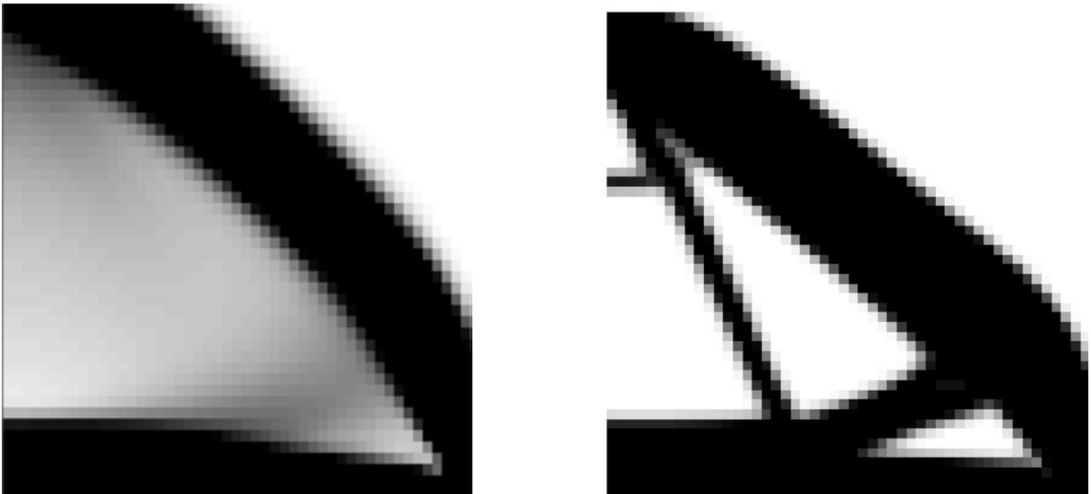
FIGURE 2.5 – Problème de la poutre en porte-à-faux (cantilever beam) :  $p = 1$  à gauche et  $p = 3$  à droite
