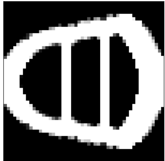
FIGURE 1.6 – Problème convectif avec canaux fluides optimisés [16]
