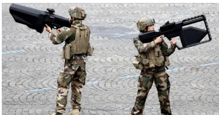
Figure 1 : Le NEROD F5 de MC2 technologies. Cette arme permet de générer une IEMI ciblée afin de forcer l'atterrissage d'un drone en toute sécurité. Photo datant du défilé militaire du 14 juillet 2019 à Paris.
