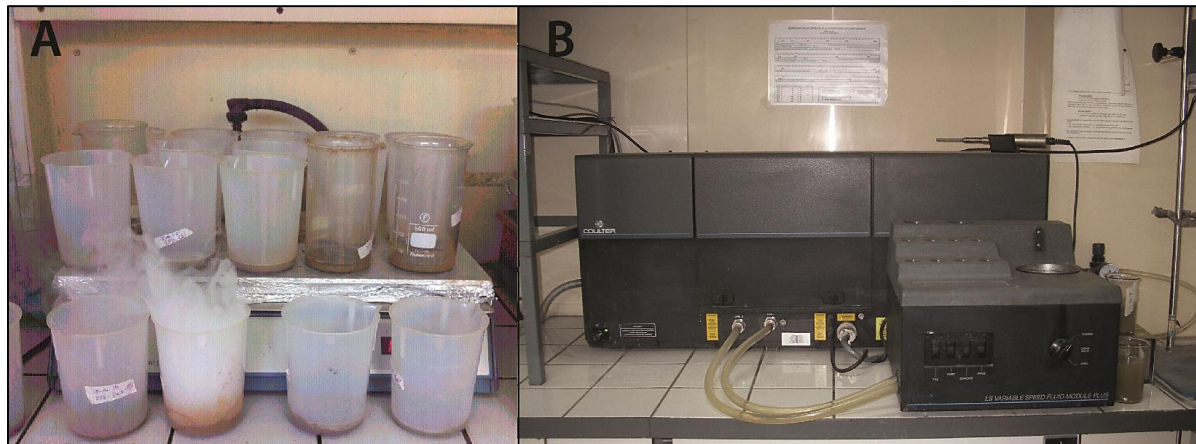
Fig. 52 – Analyse granulométrique des sédiments. A : Élimination de la matière organique au peroxyde d'hydrogène, avec un premier passage à froid puis à chaud ; B : Passage des sédiments au granulomètre laser Beckman Coulter LS 230.
