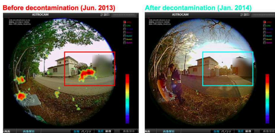
Figure 1-35 : Localisation de points chauds radioactifs sur le site de la centrale de Fukushima avec la caméra gamma ASTROCAM 7000HS : à gauche, avant décontamination ; à droite, après décontamination (Takeda et al., 2014).
