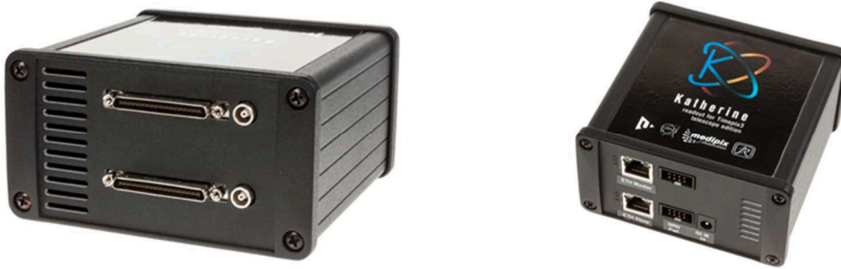
Figure 1-50 : Photographies de l'interface de lecture basée sur Katherine permettant la synchronisation de deux détecteurs Timepix3 (images fournies par Petr Burian).
