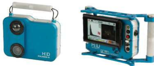
Figure 1-36 : La caméra gamma Polaris-H sans exosquelette (à gauche) et avec (à droite) (H3D, Inc., 2019).
