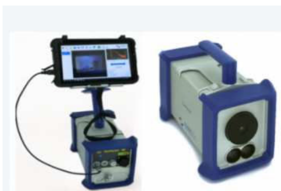
Figure 1-38 : Photographie du système de spectro-imagerie NuVISION (NuVISION, 2019) .
