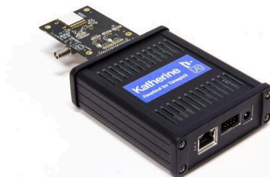
Figure 1-49 : La puce de comptage Timepix3 interfacée au système de lecture Katherine.
