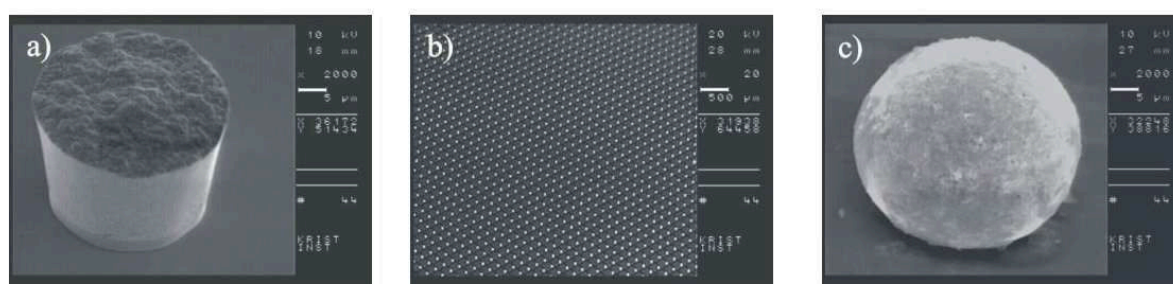
Figure 1-20 : Microbilles d'indium à différents stades : avant la mise en forme de bosse, juste après le dépôt sur la matrice (a) ; illustration d'une fraction de la matrice (b) ; après formation de la bosse (c) (Fiederle et al. , 2004).
