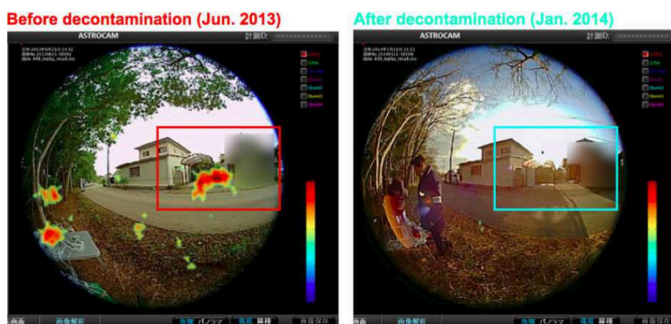
Figure 1-35 : Localisation de points chauds radioactifs sur le site de la centrale de Fukushima avec la caméra gamma ASTROCAM 7000HS : à gauche, avant décontamination ; à droite, après décontamination (Takeda et al., 2014).
