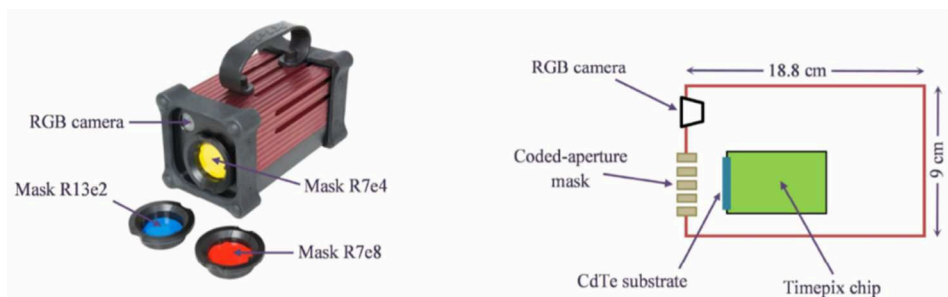
Figure 1-30 : La caméra gamma iPIX (à gauche) et une vue de coupe (à droite, échelles non respectée) illustrant ses principaux composants et dimensions. iPIX dispose de trois masques codés différents, reconnaissables par leur couleur facilitant leur identification pendant les mesures (Amgarou et al., 2016).
