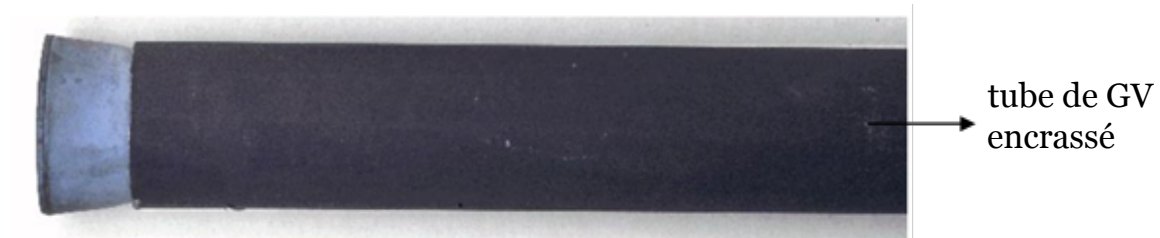
Figure 1.6: Photographie d'un tube extrait d'un GV (source : EDF)
