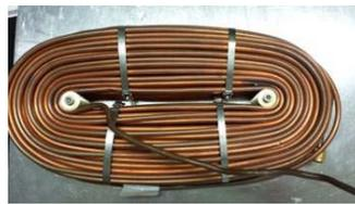
Figure 3-1 : Ligne à retard coaxiale de 20 m (134 ns)
