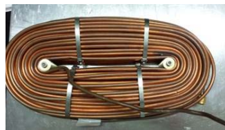
Figure 3-1 : Ligne à retard coaxiale de 20 m (134 ns)
