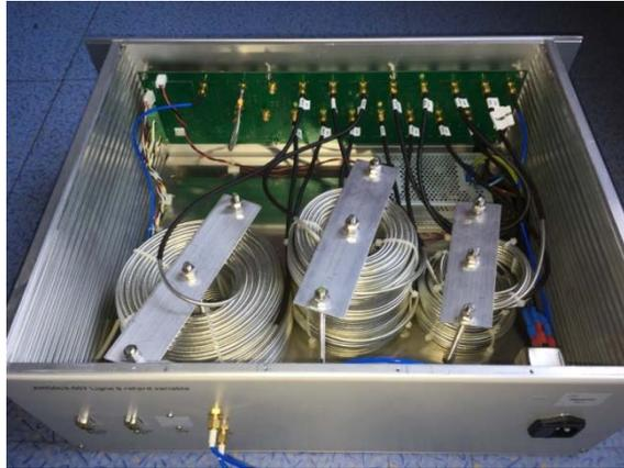
Figure 3-3 : Ligne à retard variable en technologie coaxiale
