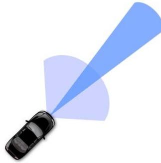
Figure 1-7 : Champs de vision du radar, ACC / AEB
