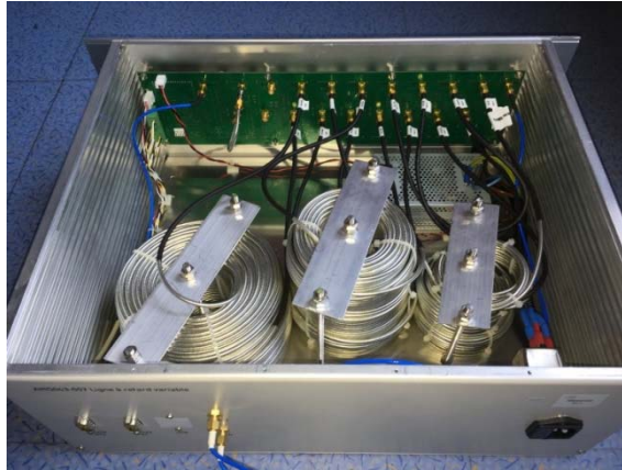
Figure 3-3 : Ligne à retard variable en technologie coaxiale
