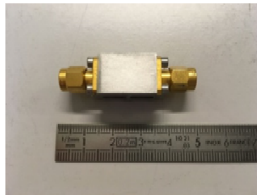
Figure 3-14 : Filtre BAW emballé - 400 ns
