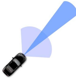
Figure 1-7 : Champs de vision du radar, ACC / AEB
