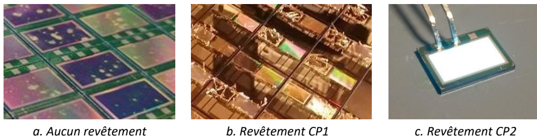
Figure III-15 : Photographie après procédé de découpe des substrats OLED en fonction de la nature du revêtement de surface.
