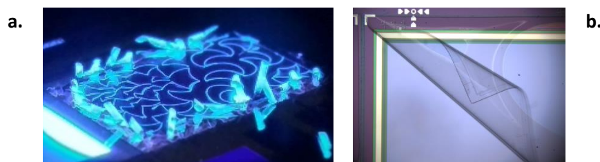
Figure III-8 : Observation sous (a) banc UV d'une OLED de test TEMA_B monochrome bleue après rupture du revêtement CP1 au bout de 24 h de stockage à 60 °C et 90%HR et (b) sous microscope optique et lumière blanche d'une OLED de test TEMA_A monochrome blanche après décollement du revêtement CP2 au bout de 300 h de stockage à 60 °C et 90%HR.
