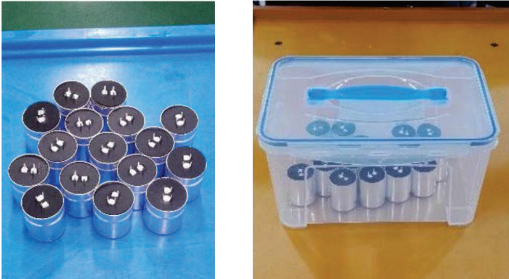
Figure 3.45 Condensateurs non scellés à l'air libre (à gauche) dans une boîte hermétique (à droite) (réf : fabricant B)
