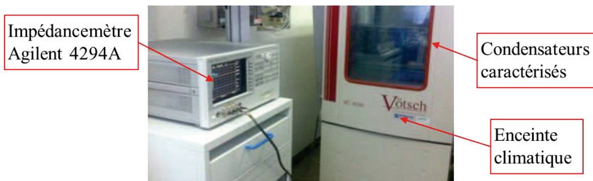
Figure 2.9 Banc expérimental pour la caractérisation des condensateurs en fonction de la température
