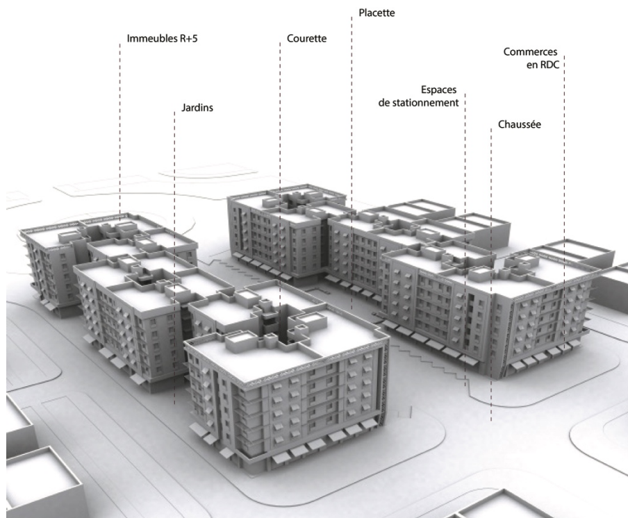
Figure 112 : Fonctionnement d'un îlot résidentiel économique, Résidence Jacaranda, Tamansourt Source : D'après la plaquette du projet collectée au format numérique : Al Omrane Tamansourt, Résidence Jacaranda, 2013 Conception : C. Kettani, 2019
