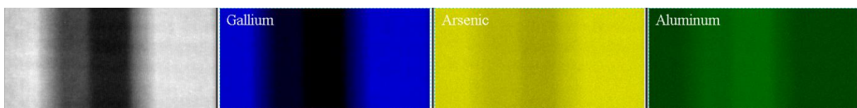
Figure IV.3-7 : Cartographies de l'intensité EELS intégrée pour le gallium, l'arsenic et l'aluminium de l'échantillon B.
