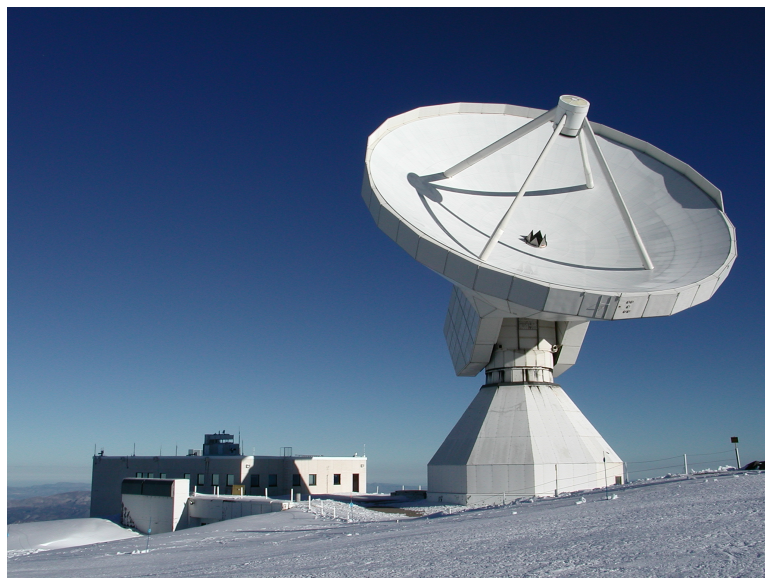
FIGURE II.1. : Radiotélescope situé au Pico Veleta (Espagne), avec son antenne parabolique de 30 m de diamètre. Géré par l'IRAM, il est connu sous le nom "30 m de l'IRAM". On distingue le réflecteur secondaire tenu par les 4 branches et le cornet ouvert, au centre du réflecteur secondaire, permettant de guider les ondes jusqu'au détecteur (non visible sur l'image). Crédits : IRAM
