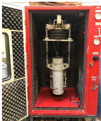
Figure II.26 Machine de vibrocompression à l'IFSTTAR de Nantes
