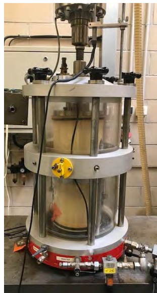
Figure II.22 Cellule triaxiale de l'IFSTAR de Nantes
