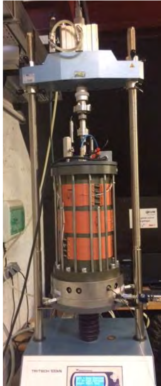
Figure II.15 Presse avec la cellule triaxiale de l'INSA de Strasbourg
