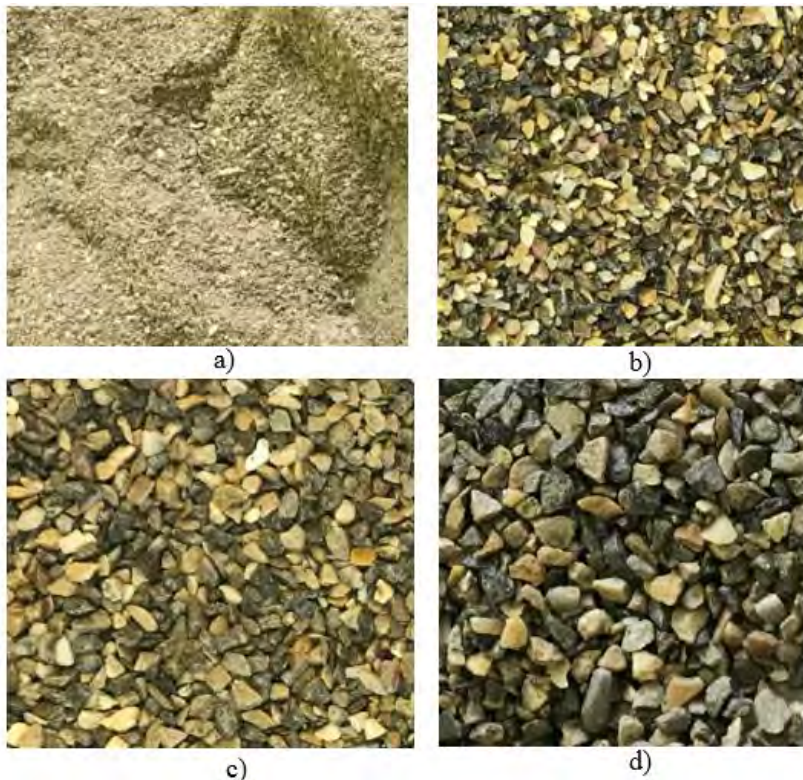
Figure II.9 Fractions granulométriques a) 0/4 b) 4/6 c) 6/10 d) 10/14
