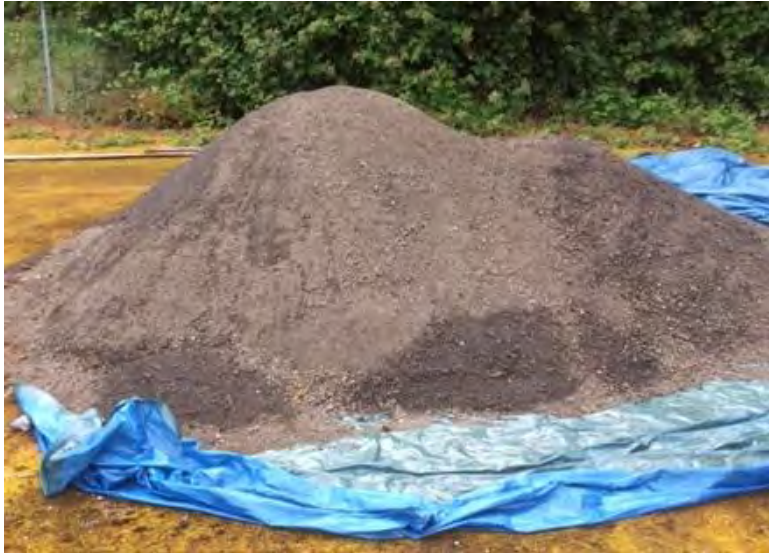
Figure II.11 Pile de stockage des agrégats d'enrobés
