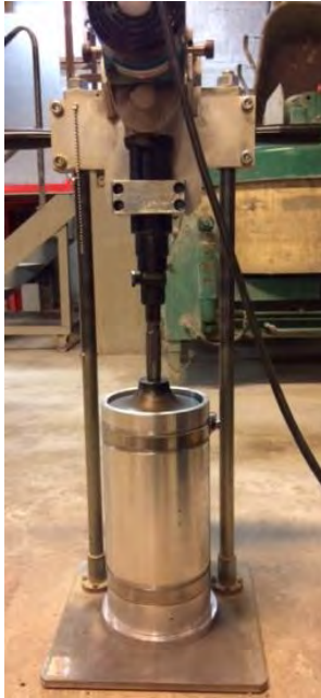
Figure II.24 Compactage au marteau vibrant à l'INSA de Strasbourg
