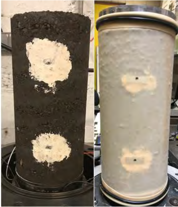
Figure II.29 Préparation de l'éprouvette pour la fixation des capteurs
