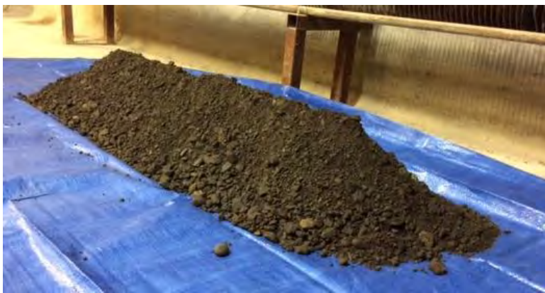
Figure II.12 Stockage intermédiaire des agrégats d'enrobés sous forme pyramidale
