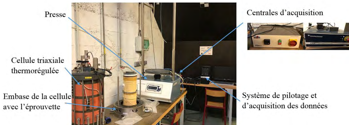
Figure II.14 Vue globale du dispositif triaxial de l'INSA de Strasbourg
