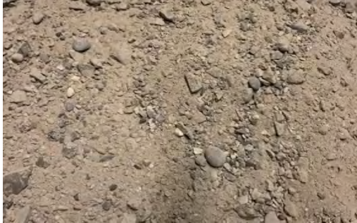
Figure II.5 Les granulats après extraction du liant des AE
