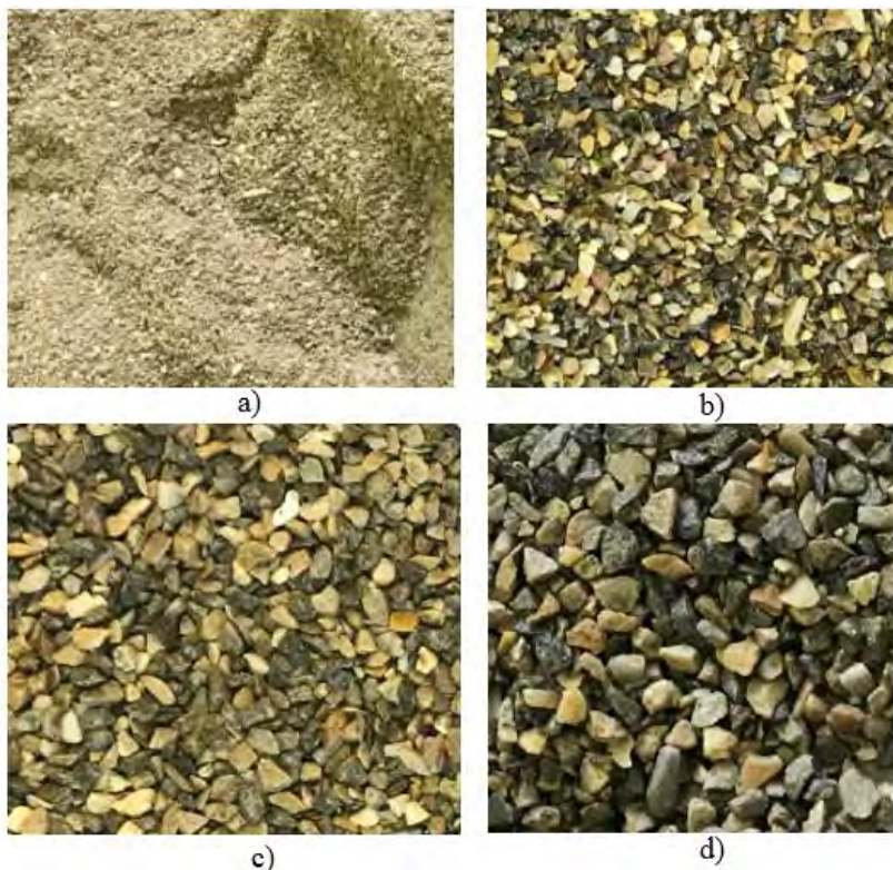
Figure II.9 Fractions granulométriques a) 0/4 b) 4/6 c) 6/10 d) 10/14
