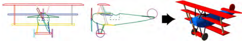
FIGURE 2.10 – Le modèle 3D est généré automatiquement par 3D modeling with silhouettes [RDI10] en calculant l'intersection des silhouettes fournies par l'utilisateur.
