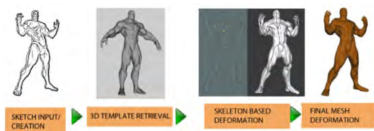
FIGURE 2.20 – Processus simplifié de la méthode Efficient Sketch-Based Creation of Detailed Character Models through Data-Driven Mesh Déformations [KYY + 15]. Un modèle référent est recherché dans la base de données à partir du dessin, et celui-ci est ensuite déformé pour correspondre au croquis.
