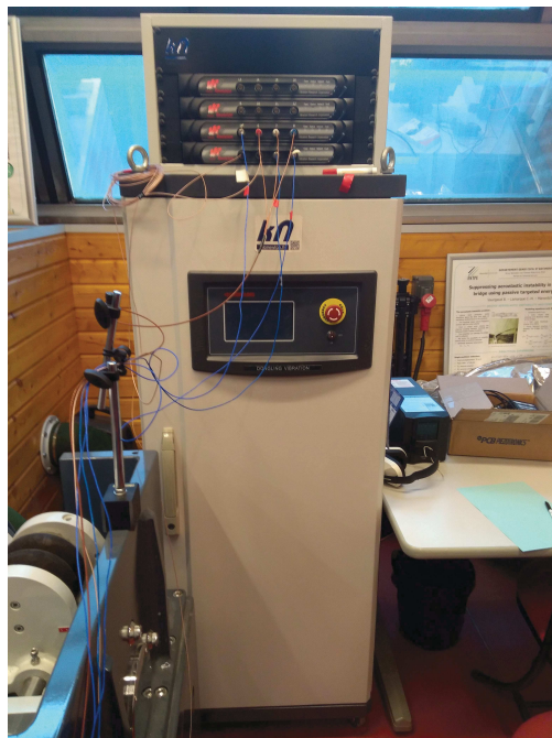
FIGURE B.2 – Photo de l'amplificateur de puissance du vibreur électrodynamique sur lequel est posée l'unité d'acquisition.
