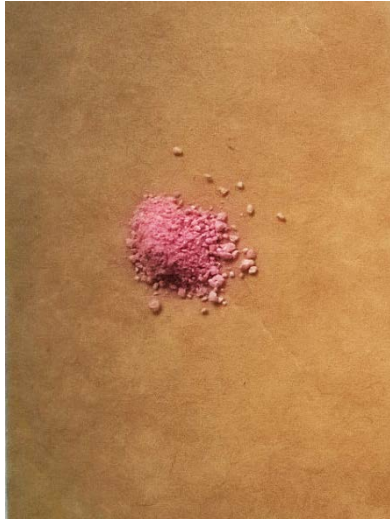
Figure 9 - Matériau composite obtenu avant (a) et après (b) traitement thermique (180 °C sous vide) et redispersion dans le 1-butanol.
