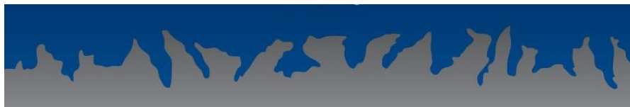
Fig. 5. Représentation schématique de l'ancrage mécanique d'un adhésif ou revêtement (bleu) dans la rugosité du substrat (gris).
