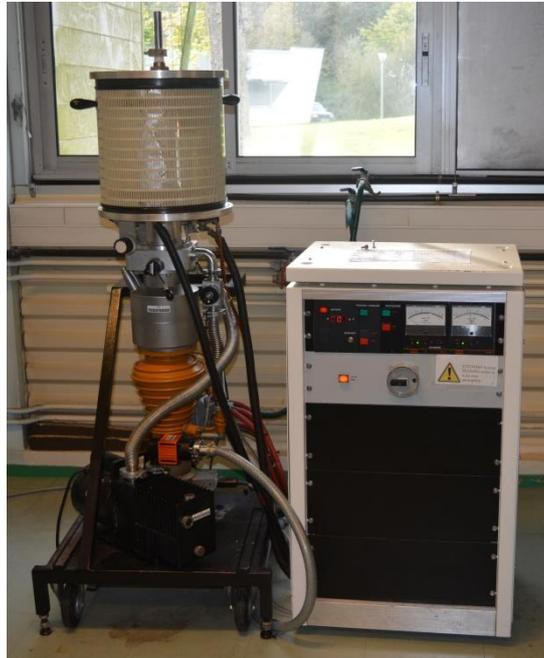
**Fig. 18. Enceinte de dépôts de films minces métalliques.**
