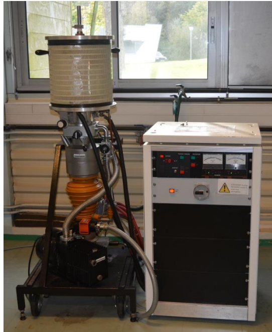
Fig. 18. Enceinte de dépôts de films minces métalliques.
