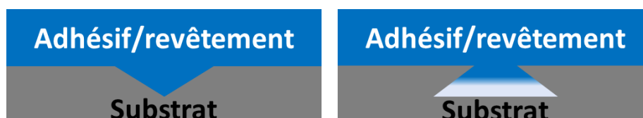
Fig. 6. Représentation du recouvrement total de l'adhésif dans la texture (gauche) et partiel dans des structures plus complexes (droite).
