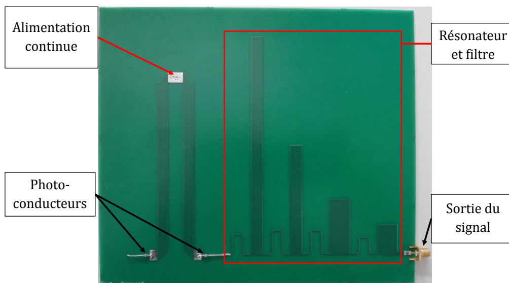
FIGURE III.30 – Générateur optoélectronique de fréquence centrale visée f_c = 190 MHz
