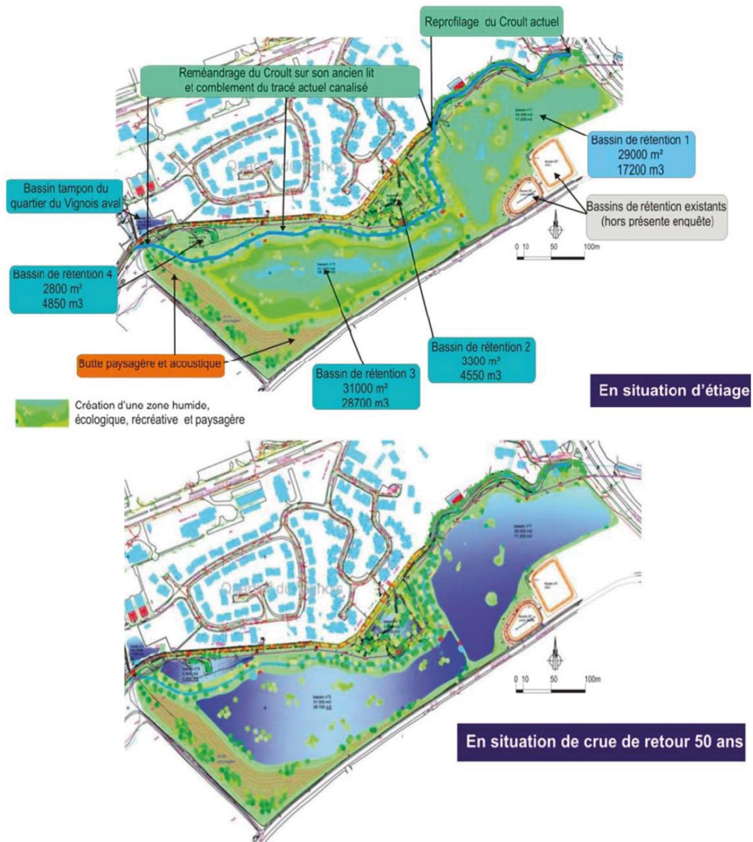
Figure 7.35 Schémas du réaménagement du Croult et de la zone humide associée
