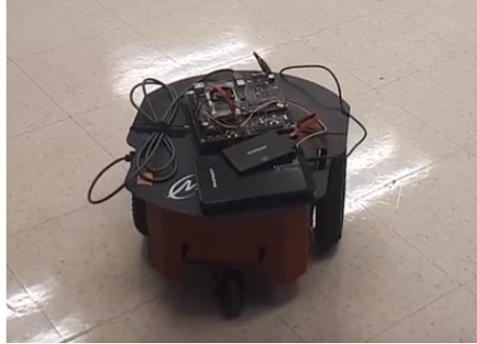
FIGURE 2.15 – Carte microprocesseur et carte de transmission sans fil
