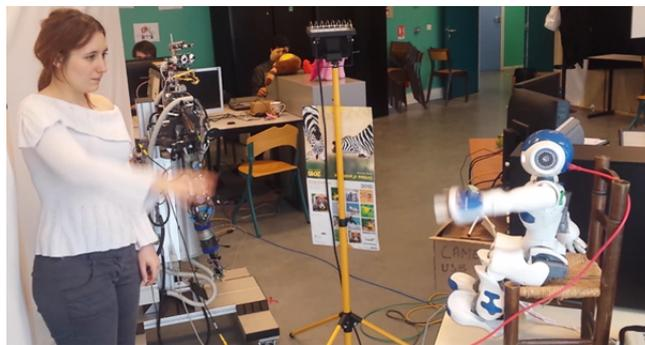
FIGURE 7.4 – Contexte expérimental : apprentissage d'un geste rythmique en synchronisation entre un NAO et un humain
