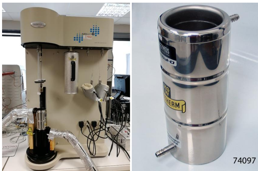
Figure 3-6. Système de régulation avec le Dewar à double enveloppe.
