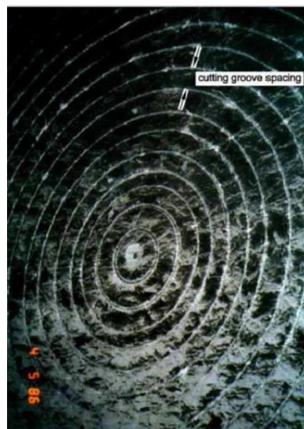
Fig. 1.14. Traces concentriques et circulaires du sol après le contact avec les disques à molette.
