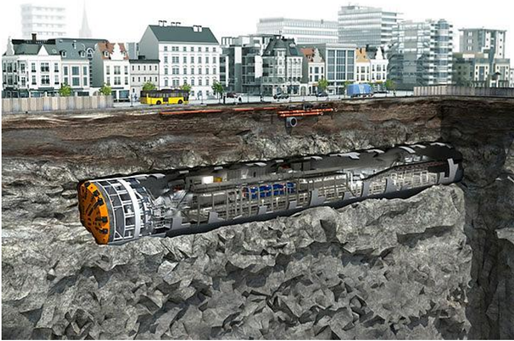
Fig. 1.2. Image présentant un tunnelier créant un tunnel.
