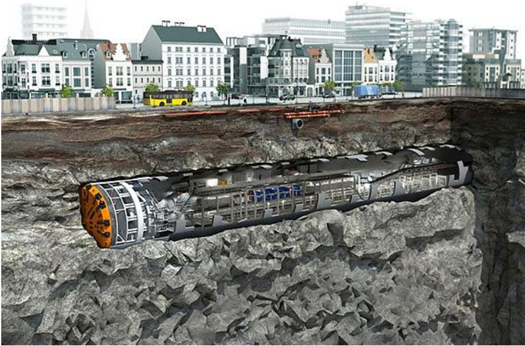
*Fig. 1.2. Image présentant un tunnelier créant un tunnel.*
