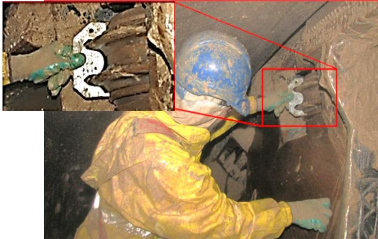
*Fig. 1.27. Opérateur au niveau de la roue de coupe du tunnelier analysant l'usure des disques <sup>57</sup>.*
