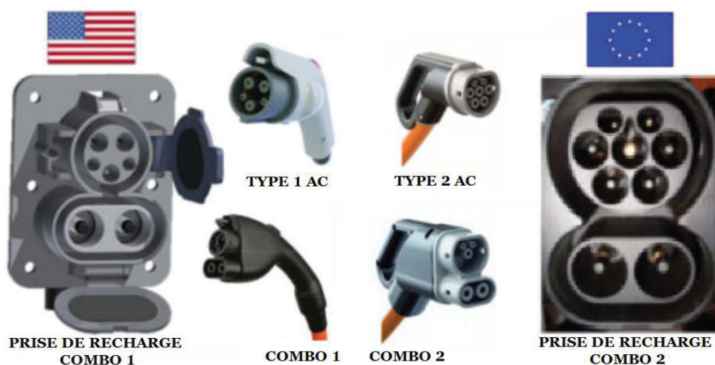
Figure V.5 – Le système de charge combiné CCS [177]
