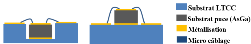
Figure 53. Micro-câblage entre une puce et substrat LTCC avec cavité (gauche) et sans cavité (droite)
