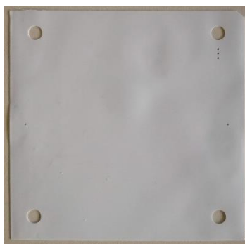
Figure 18. Tape ESL41010 avec trous d'alignement et trous d'orientation
