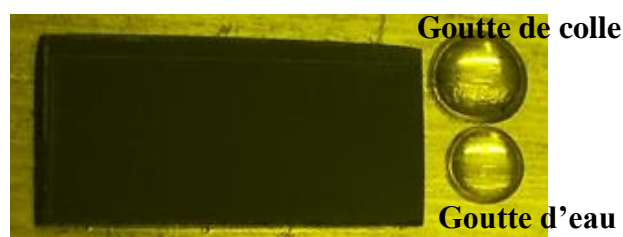
Figure 123. Goutte d'eau et goutte de colle placées en face de l'ouverture du micro-caloduc
