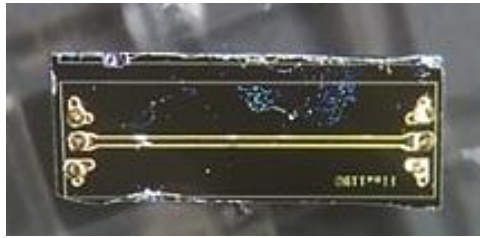
Figure 67. Puce avec des billes de diamètre 54\ \mu\text{m}
