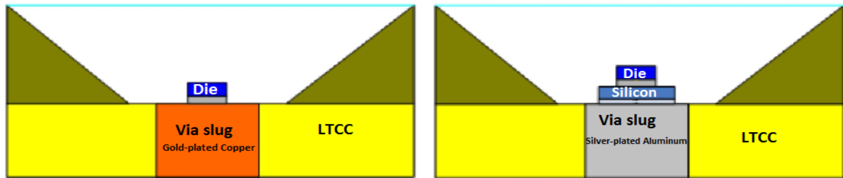
Figure 92. Photo des deux solutions : bloc de cuivre plaqué or (à gauche) et bloc d'aluminium plaqué argent (à droite) intégrés dans le substrat LTCC au-dessous de la puce LED [65] © [2012]
