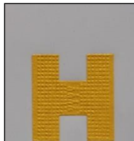
Couches 1, 2, 3, 4 et 5 après sérigraphie des couches conductrices
