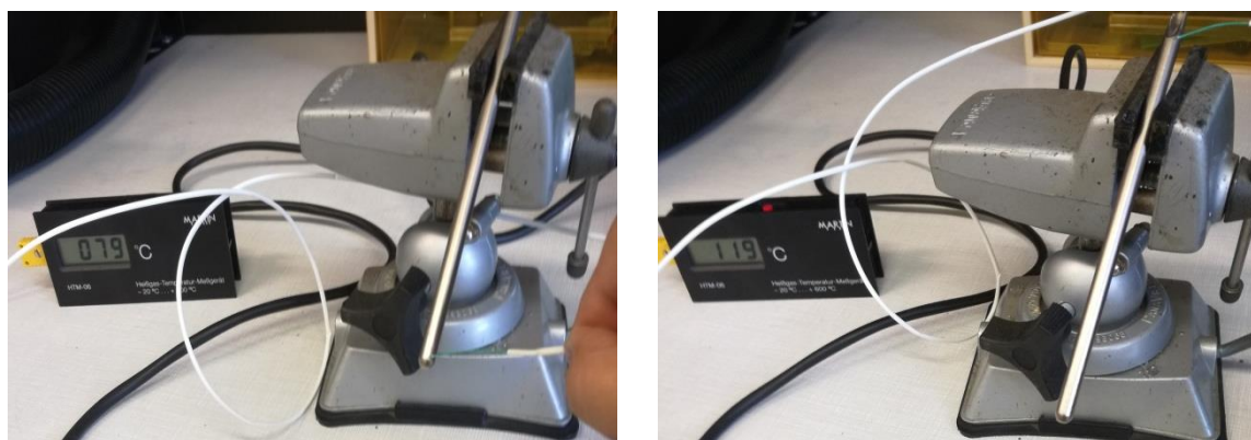
Figure 99. Mesure du caloduc
