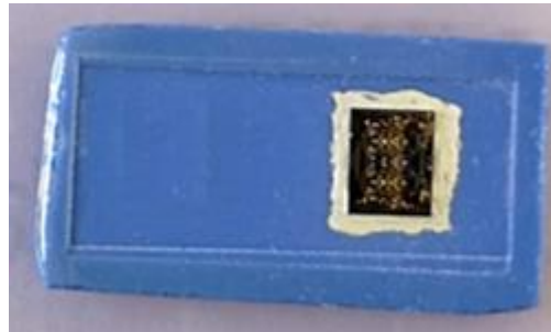
Figure 124. Amplificateur de puissance collé sur la surface d'un micro-caloduc
