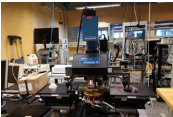
Figure 125. Banc de mesure thermique (gauche) micro-caloduc sur lequel placé l'amplificateur alimenté à travers des pointes DC (droite)
