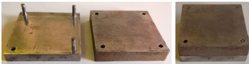
Figure 21. Support d'empilement des couches LTCC utilisé au laboratoire
