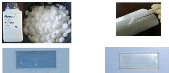
Figure 110. Photos de la cavité remplie par l'alcool cytélique fondu (gauche) et par les feuilles de PMMA (droite)
