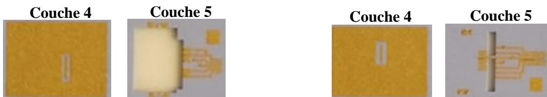
Figure 163. Couches 4 et 5 pour le montage du multiplieur par micro-câblage (à gauche) (conception donnée à la figure 149) et par flip-chip (à droite) (conception donnée à la figure 151)
