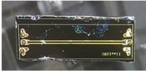
Figure 67. Puce avec des billes de diamètre  $54\ \mu\text{m}$
