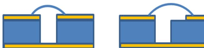
Figure 46. Micro-câblage entre deux lignes sans (à gauche) et avec (à droite) substrat autour des plots
