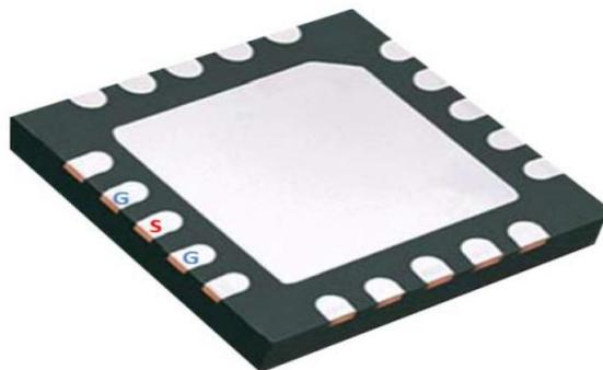
Figure 3. Boîtier QFN conçu pour la bande E [8] © [2013]
