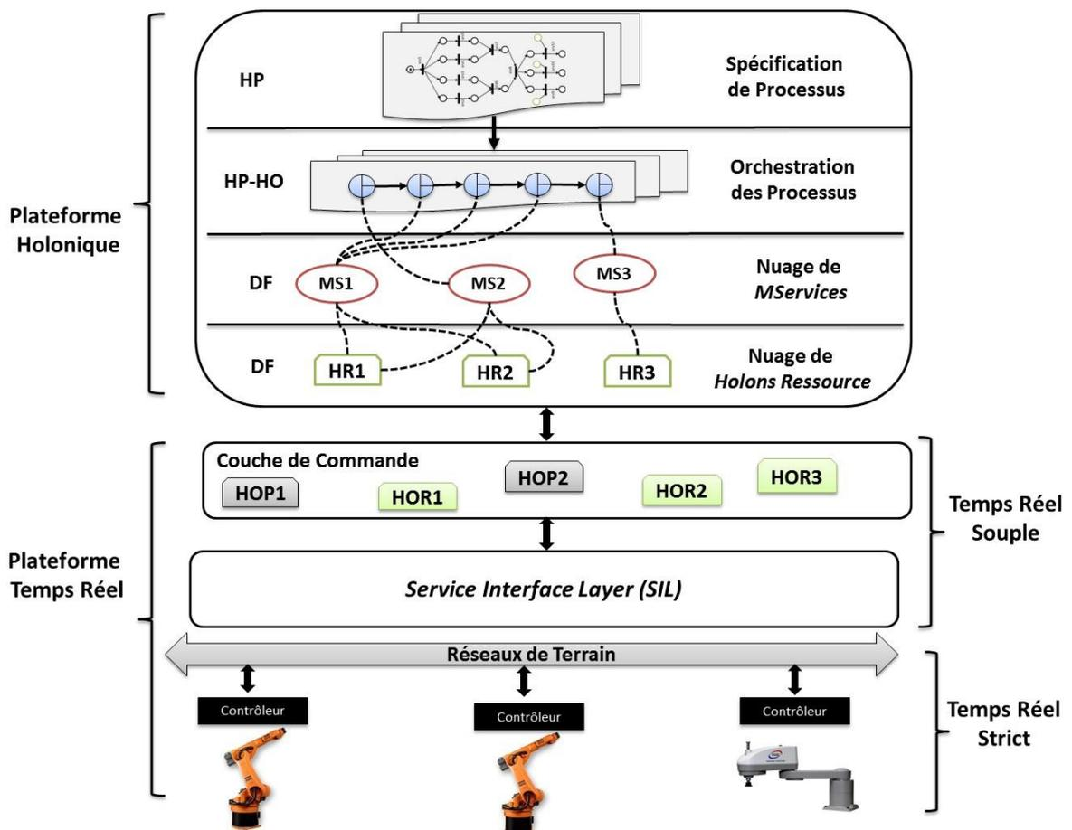
Figure 42 Architecture de commande d'un SOHMS
