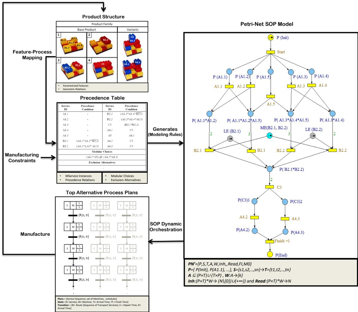
Figure 56 Modèle de processus orienté-services en RdP
