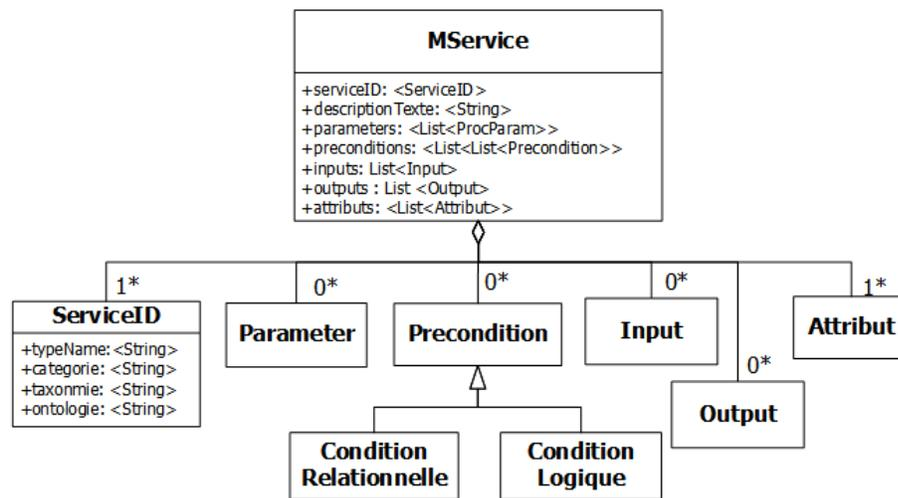
**Figure 26** Modèle de *MService* (service de production)
