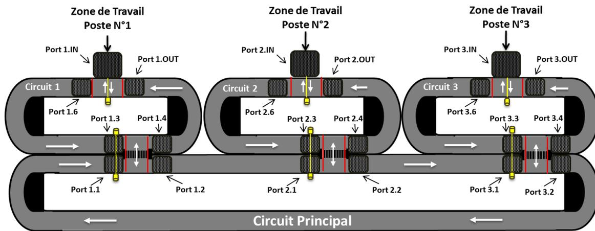
**Figure 80** Système de Transport et Localisation des Ports
