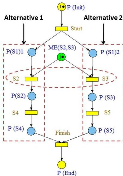
Figure 47 Alternatives dans un modèle *SOP* en RdP
