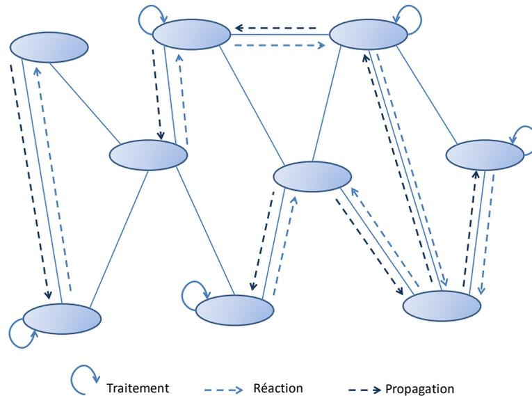
**Figure 2** Structure hétéroarchitecturale de contrôle (Blanc, 2006)
