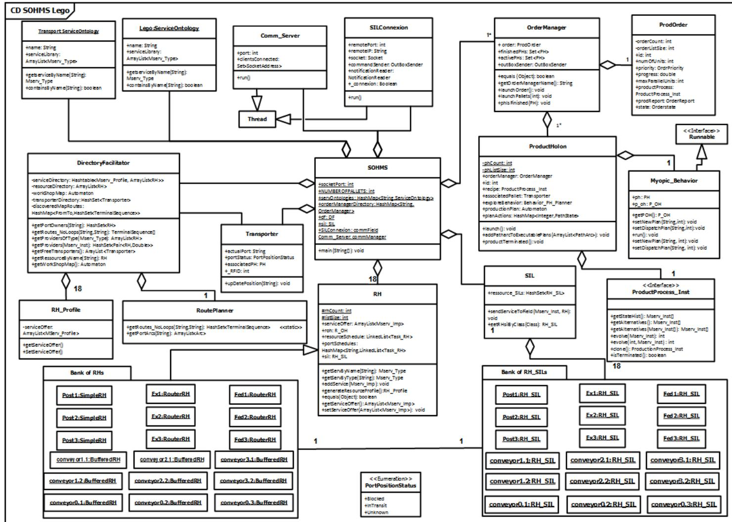
Figure 96 Architecture du SOHMS pour l'application Lego
