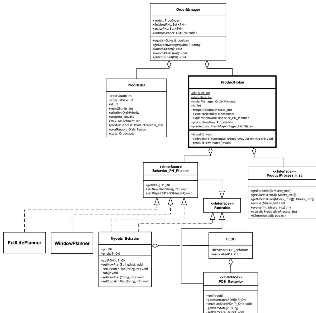
Figure 36 Diagramme de Classes UML : l'Holon Produit
