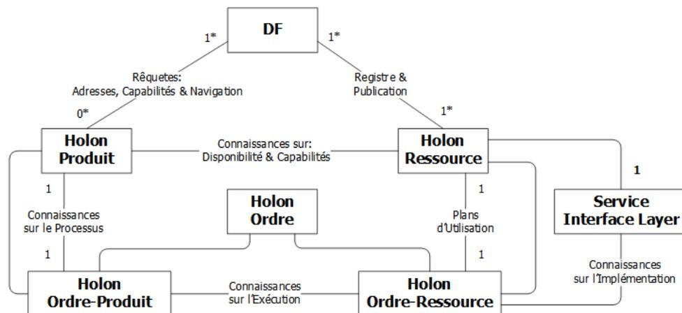
**Figure 35** Diagramme de Classes UML de l'architecture *SOHMS*
