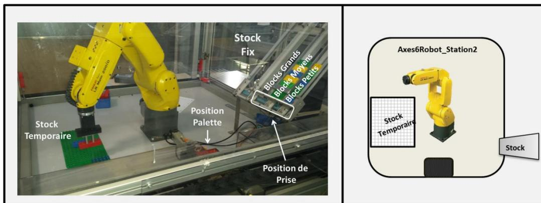
**Figure 79** Poste de Travail N°2 et 3 (identiques) : Opérations d'Assemblage de Blocs Lego
