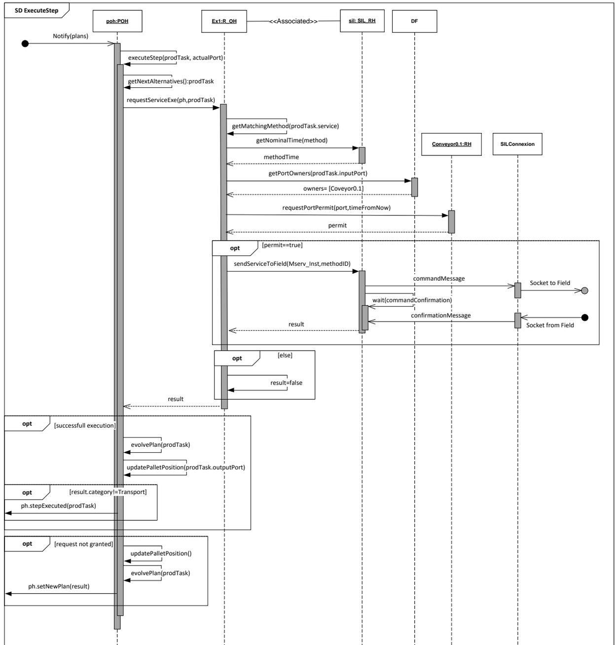
**Figure 104** Scénario d'exécution d'un service de transport par l'échangeur Ex1 vers Conveyor1.1 dans le contexte de l'exécution d'un pas de production.
