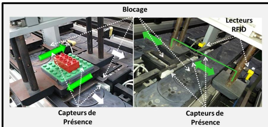
**Figure 81** Mécanisme de Transfert inter-convoyeurs
