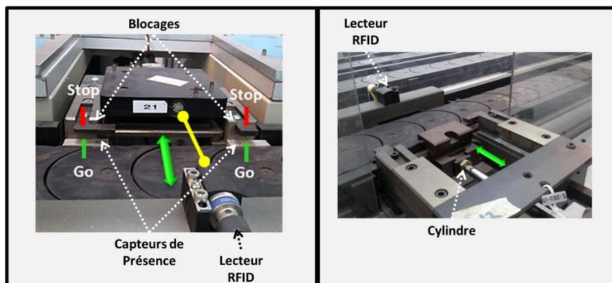
**Figure 82** Mécanisme de transfert des palettes aux postes de travail.
