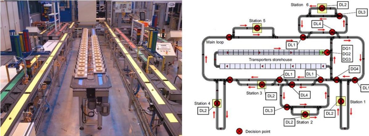
**Figure 3** Système contrôlé par le produit *niveau 1* (Cardin and Castagna, 2009)
