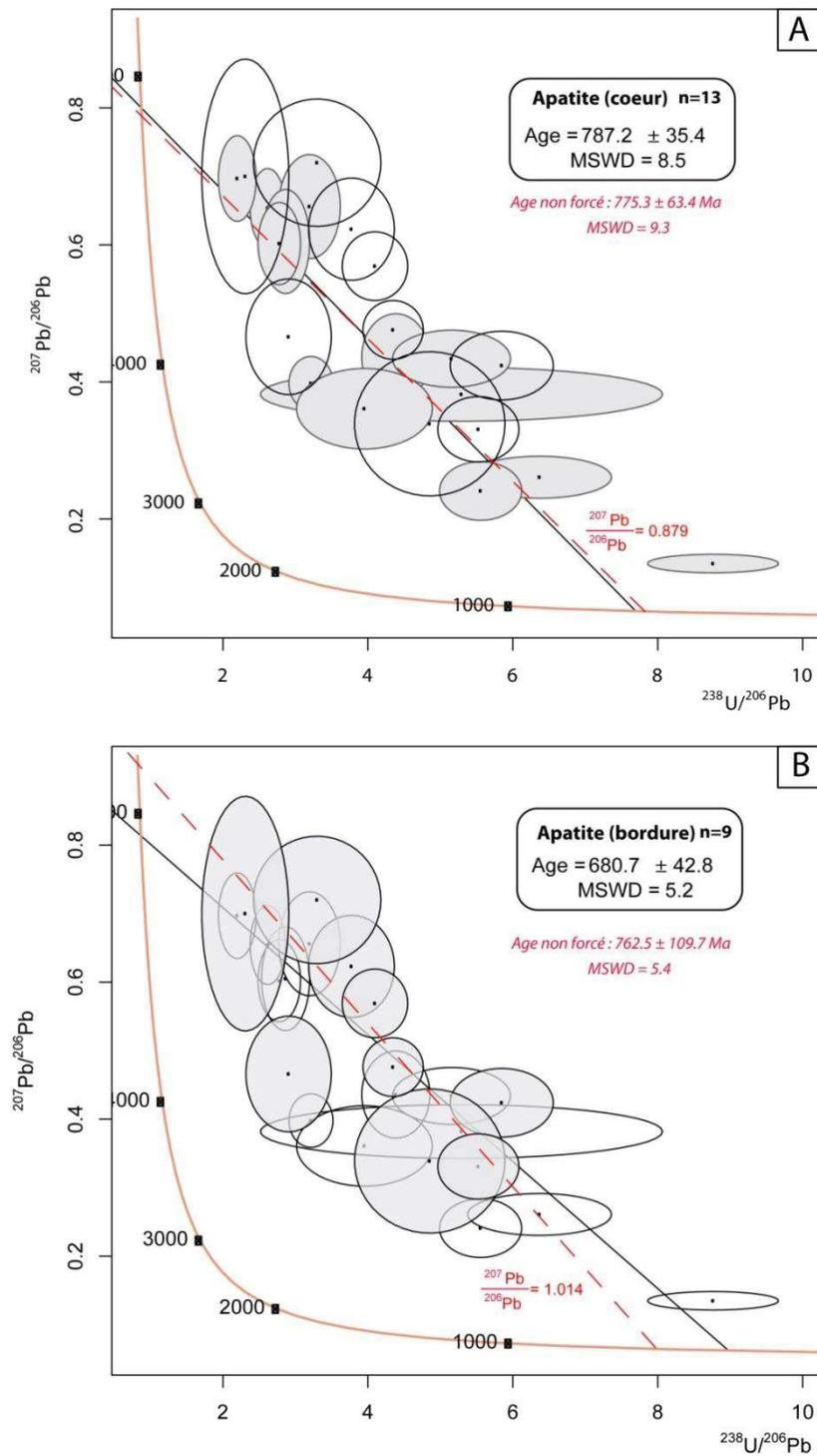
Figure V.9 : A) Discordia Tera-Wasserburg avec la date corrigée en plomb commun ( $^{207}\text{Pb}$ ) définie avec 13 analyses aux cœurs des apatites. B) Discordia Tera-Wasserburg définie avec 10 analyses des bordures des apatites (ligne rouge : date non forcée, rond grisé : analyse utilisée pour le calcul de l'âge)
