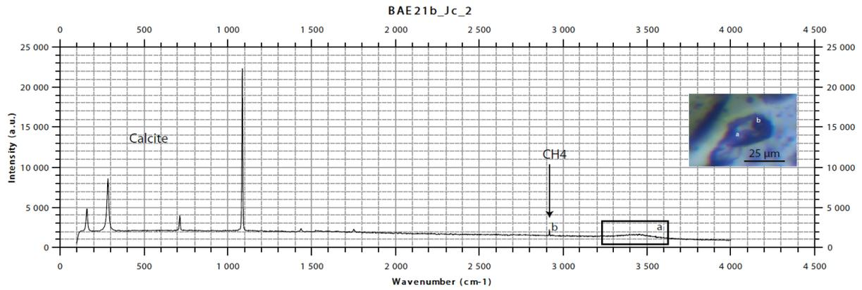
Figure III.1 : Spectre Raman indiquant la nature du liquide (H<sub>2</sub>O) et de la bulle de vapeur (CH<sub>4</sub>)
