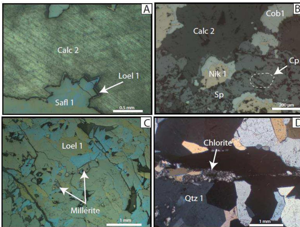
Figure II.19 : Gangue carbonatée formée au début A) du stade à Fe représenté par la mise en place de la loellingite et des carbonates autour de la safflorite, B) du stade à sulfures où la sphalérite et la chalcoppyrite se forment. C) Exemple de millérite observée lors des stades tardifs à Fe (images en lumière réfléchie). D) Exemple de gangue siliceuse composée de quartz à texture en mosaïque associée à des veines tardives à chlorite (image en lumière polarisée)
