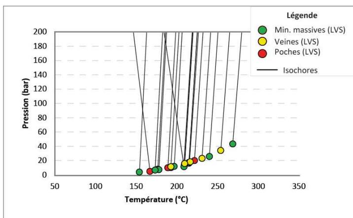
Figure VI.3 : Diagramme de pression/température des données de fluide de Bou Azzer
