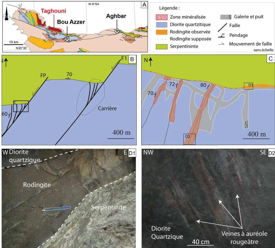
Figure II.10 : A) Localisation du gisement de *Taghouni*, la légende est la même que la figure II.1. B) Carte en surface du chantier de *Taghouni*. C) Zoom des veines minéralisées et du contact rodingitique entre la serpentinite et la diorite quartzique. D1) Photo du contact rodingitique. D2) Réseau de veines à auréoles d'altération dans la diorite quartzique
