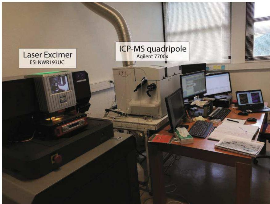
Figure V.1 : Laser Excimer couplé à un ICP-MS quadripôle du laboratoire de Géosciences Rennes
