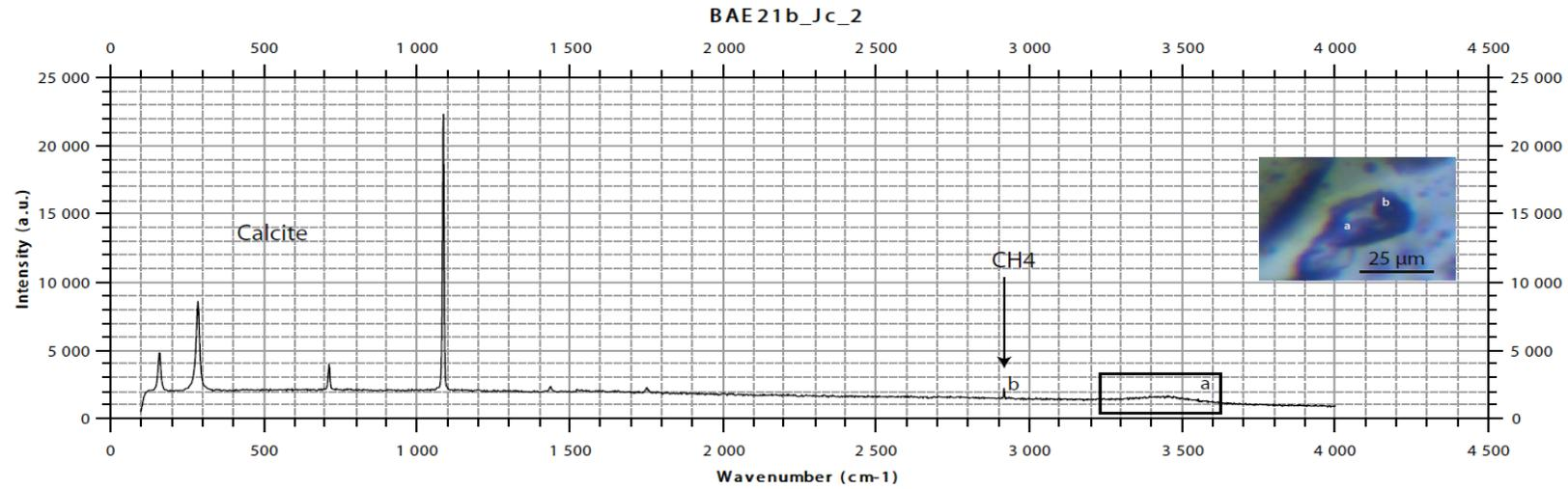
Annexe III.2B : Spectre Raman de la phase vapeur de CH<sub>4</sub> d'une inclusion monophasée en vapeur
