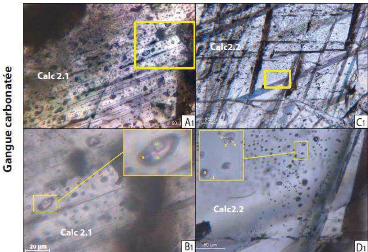
Figure III.9 : A1-C1-A2-C2-E2) Photographie au microscope optique et en lumière naturelle représentant une vue globale de la distribution des inclusions fluides au sein des différentes générations de minéralisations à l'échelle du minéral. B1- D1-B2-D2-F2) Vues rapprochées des inclusions fluides représentatives (calc : calcite, qtz : quartz)
