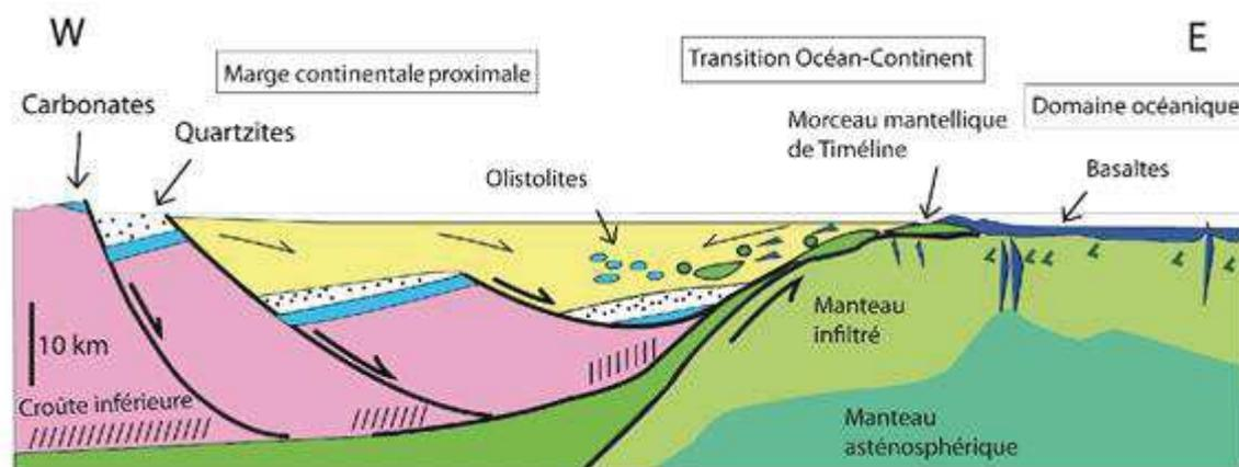
Figure I.2 : Reconstruction schématique pré-800 Ma (sans échelle) de la transition océan-continent au NE du Mali (Caby, 2014)
