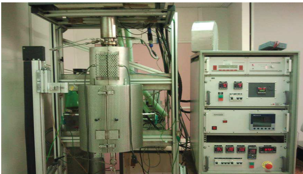
Photo II.2 : Équipement pour l'analyse thermogravimétrique (ATG)
