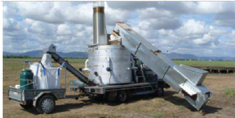
Photo I.1 : Équipement mobile de pyrolyse (Van Zwieten et al. , 2011)
