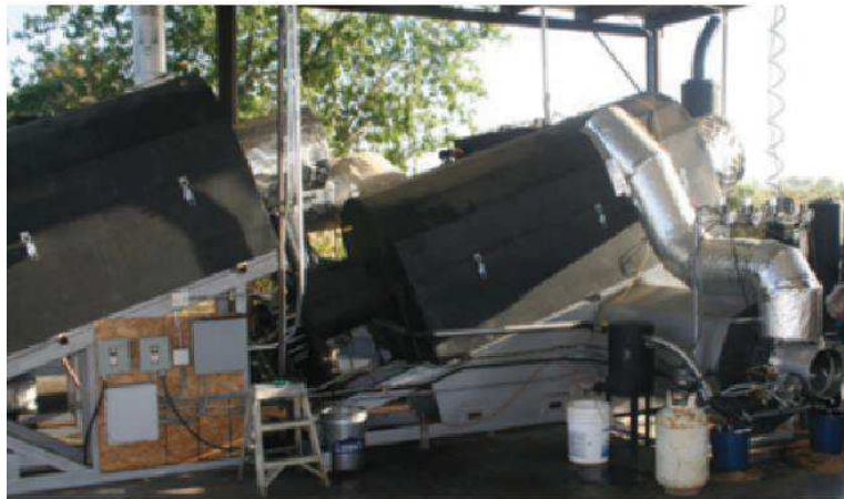
Photo I.2 : Équipement de pyrolyse fixe en continu (Van Zwieten et al. , 2011)
