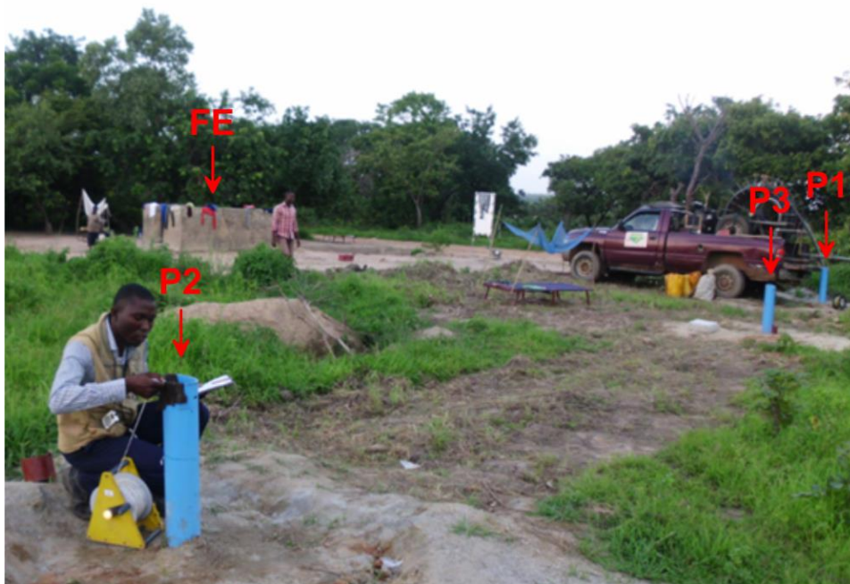
Figure 3.2 – Présentation de la disposition des piézomètres et du forage en exploitation sur chaque site : exemple du site FD17.
