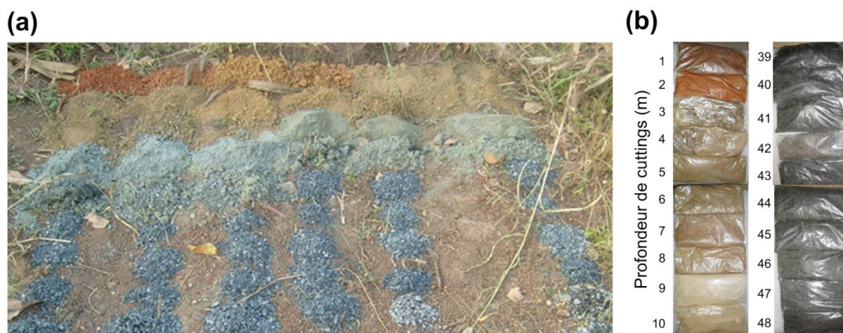
Figure 3.8 – Présentation des cuttings du forage P1 du site FD30. a) planche de cuttings, b) cuttings échantillonnés dans des sacs de congélation ( e.g. 10 premiers et 10 derniers mètres).
