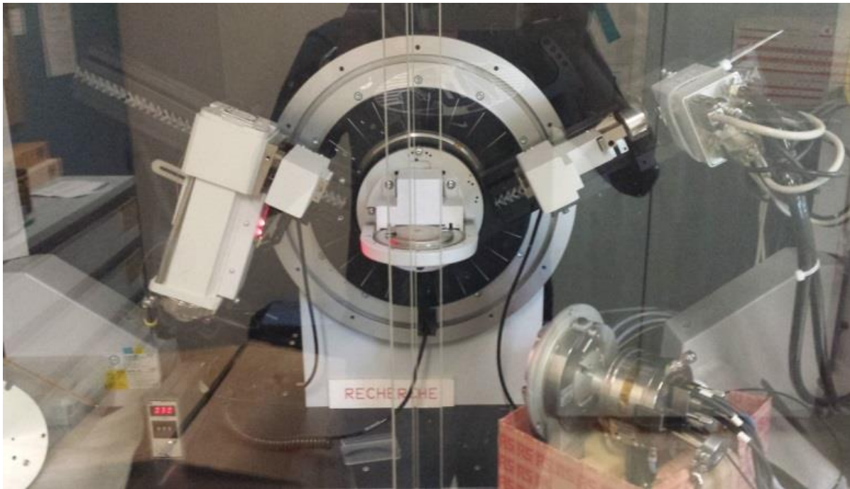
Figure 4.4 – Image du diffractomètre à rayons X utilisé pour cette étude (diffractomètre à rayons X D5000 de l'Institut des Sciences de la Terre (ISTerre) de l'Université Grenoble Alpes, en 2016).
