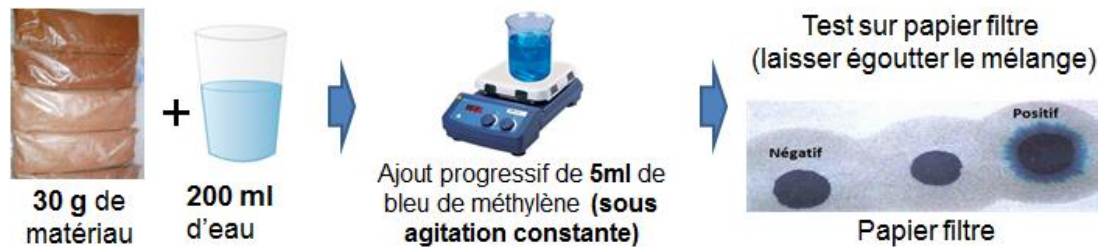
Figure 4.8 – Procédure du test de bleu de méthylène.
