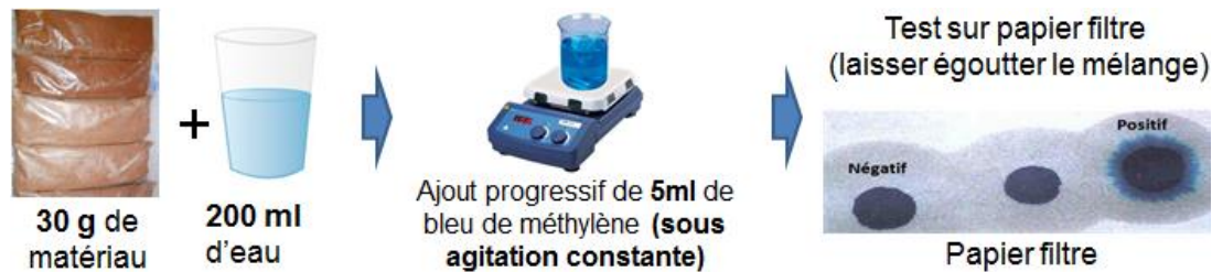
Figure 4.8 – Procédure du test de bleu de méthylène.
