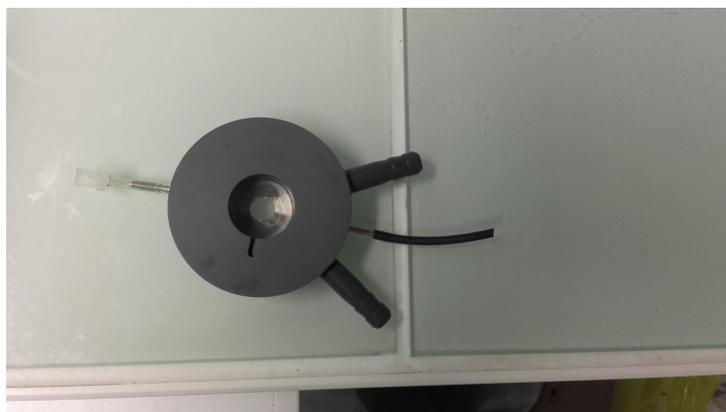
**Figure 4.38:** Photo de la cuve utilisée pour le montage à circulation
