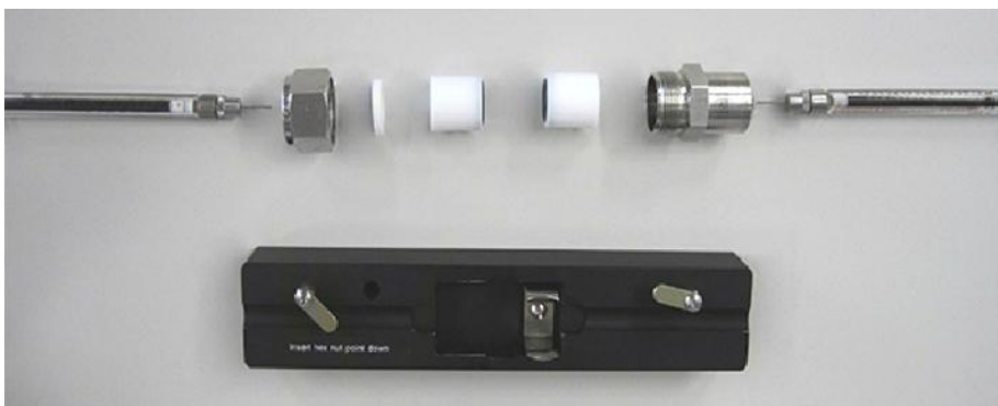
Figure 40 : Montage d'extrusion. Un filtre avec des pores calibrés est inséré au centre, entre les deux cylindres de téflon. Par pression sur les seringues, la suspension de lipides traverse plusieurs fois le filtre, contraignant les vésicules formées à adopter une taille proche de celle des pores.
