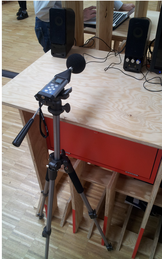
FIGURE A.4. – Dispositif d'étalonnage avec un sonomètre (premier plan) en face d'enceintes. Les enceintes sont utilisées pour gérer un bruit rose à différentes intensités sonores.
