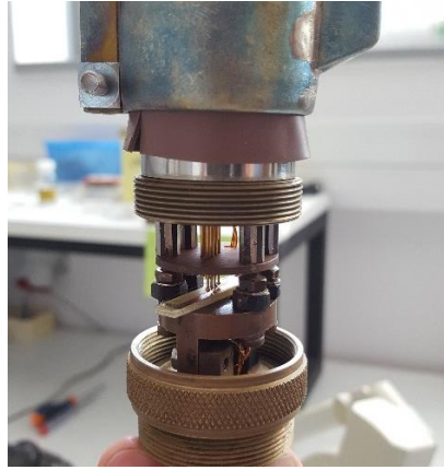
Figure 2.10: Présentation du dispositif expérimental et du schéma présentant la mesure 4 points. La distance deux points contiguës est de 1 mm.
