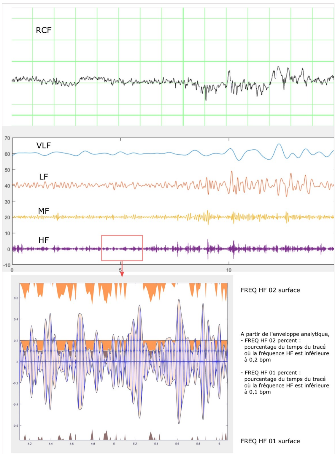
Figure 2. 8 : Calcul de 2 enveloppes analytiques pour chaque bande de fréquence Pour chacune des enveloppes, estimation de son pourcentage et de sa surface.
