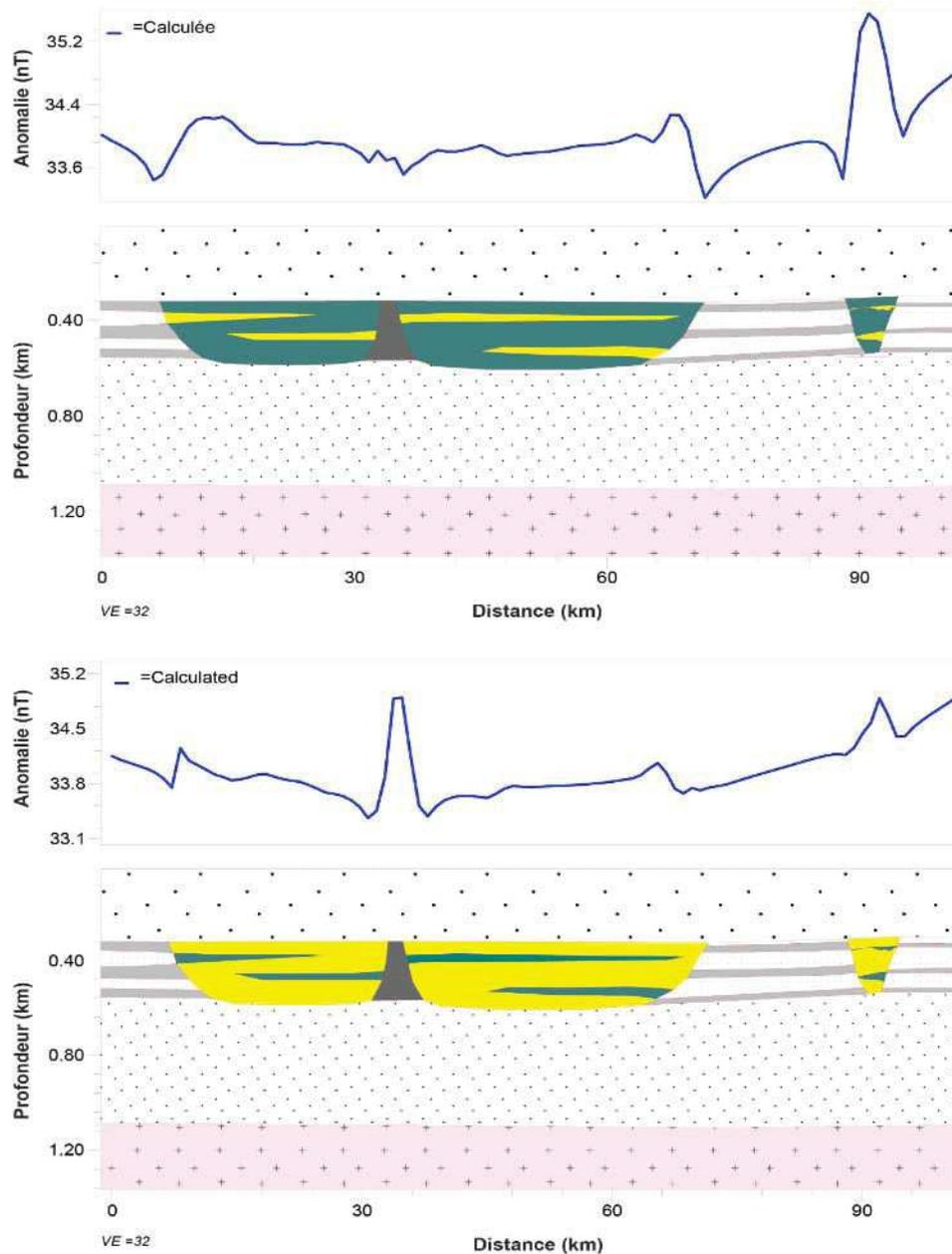
**Figure V-15 :** Modélisation à deux dimensions d'un système glaciaire qui se compose d'une vallée tunnel-V1, une large vallée glaciaire- V2 de type ice-stream comprenant une crête préglaciaire. A) Le remplissage des vallées est de nature argileux ; B) Le remplissage des vallées est de nature gréseux. Dans les deux cas, le paléorelief au centre de la grande incision est de nature argileuse.
