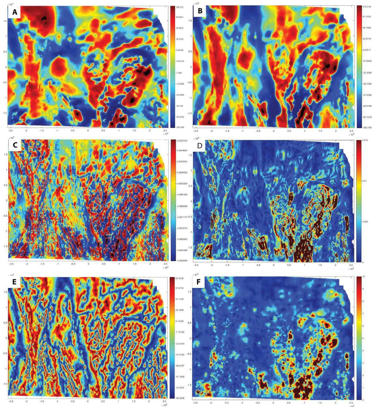
**Figure II-17 :** Application des différents opérateurs de transformation sur (A) la carte d'anomalie magnétique du bassin d'Illizi (IL32) ; (B) carte de double réduction au pôle ; (C) carte de dérivée verticale fractionnelle à l'ordre 1.3 ; (D) Carte du gradient horizontal à l'ordre 1 ; (E) Carte de Tilt-depth ; (D) Carte du signal analytique.
