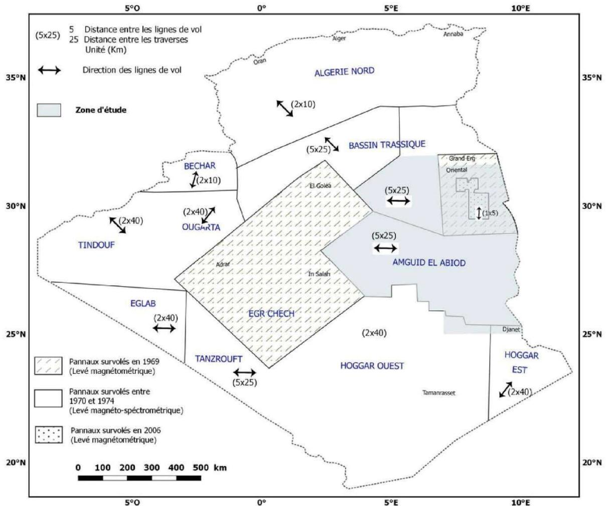
Figure II-1 : Localisation et paramètres des levés aéromagnétiques couvrant le territoire algérien.
