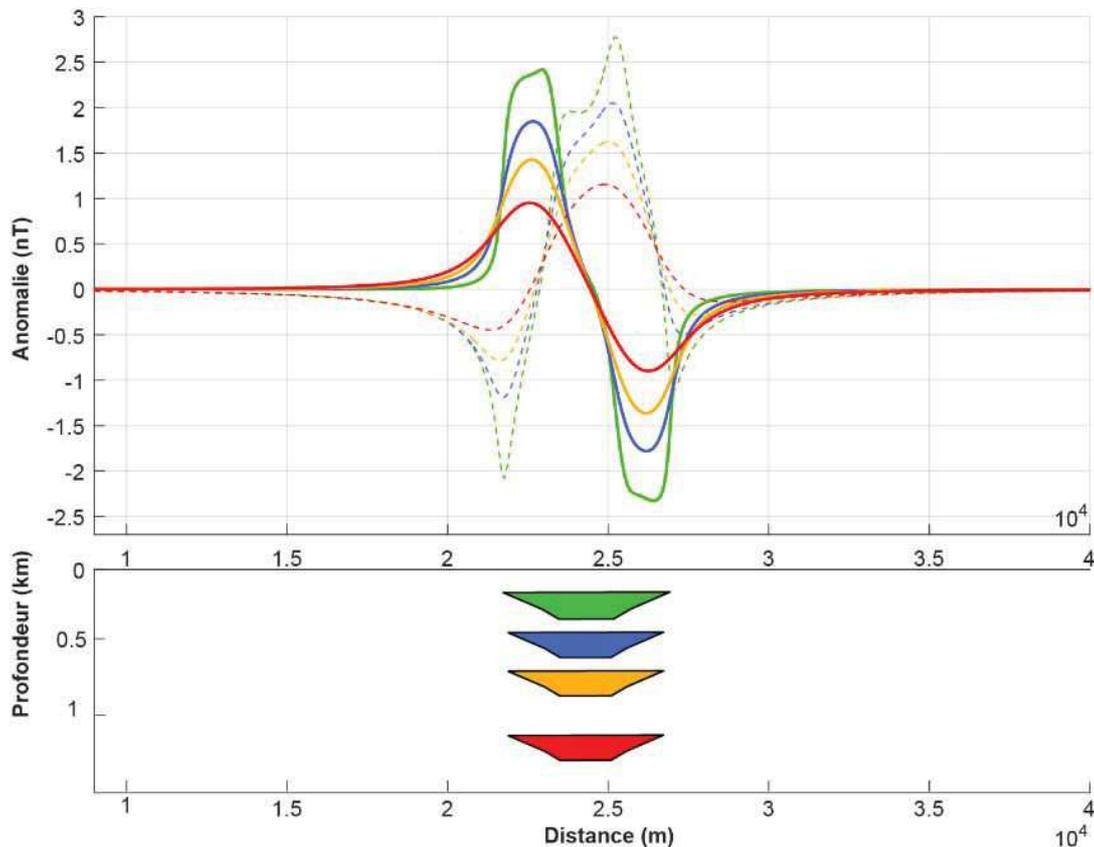
**Figure V-14 :** Modélisation à deux dimensions d'une vallée à différentes profondeurs sous une pile sédimentaire magnétiquement homogène : 160 m (verte), 460 (bleu), 760 (orange), 1360 (rouge). La valeur de susceptibilité est de 0.00009.
