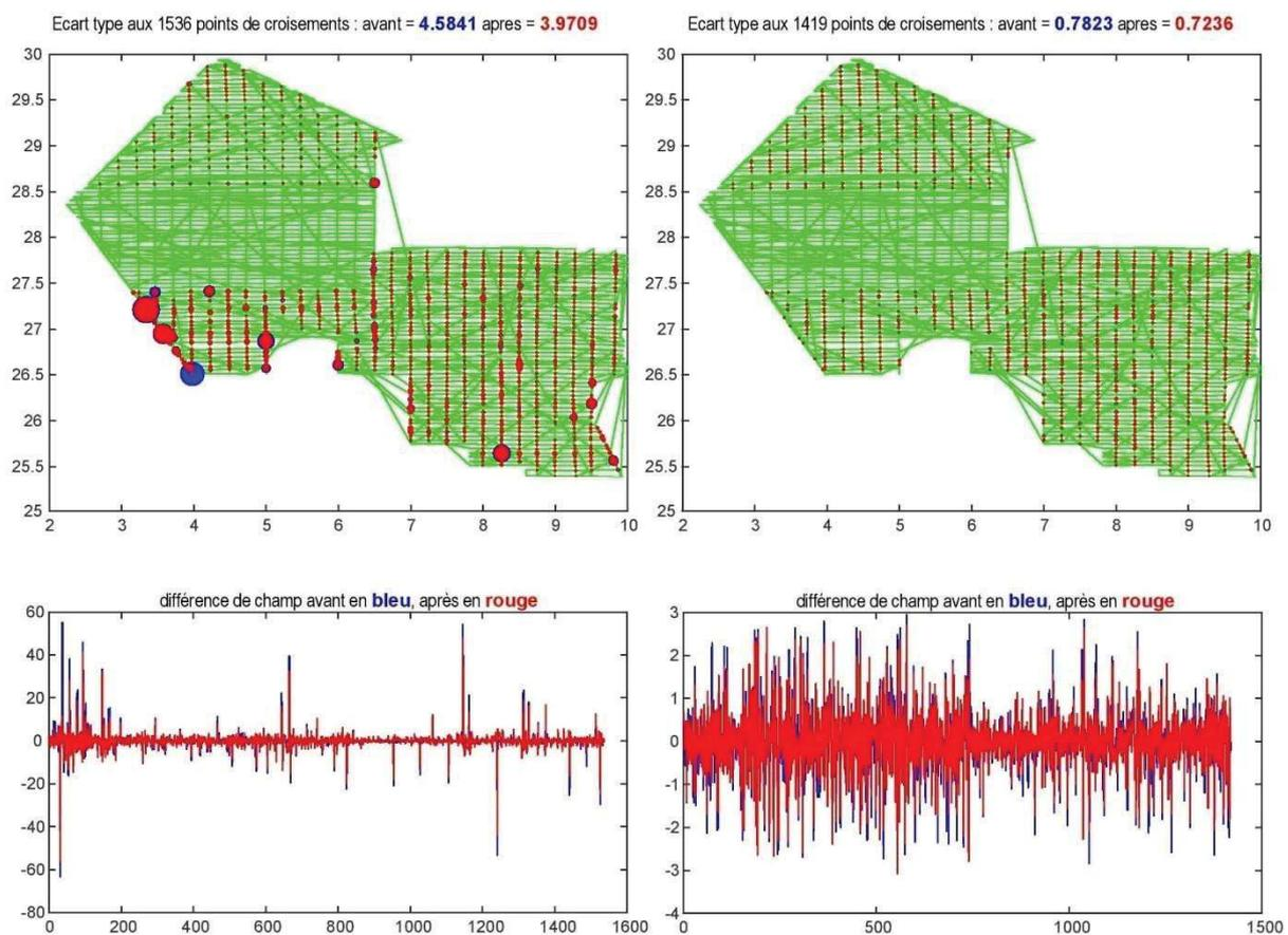
**Figure II-4 :** Réduction des écart-types des différences de champ magnétique aux points de croisement pour le levé AM321. Valeurs des différences de champ magnétique initiales en bleu et après calcul des constantes en rouge. La partie gauche de la figure montre les résultats sans seuil et la partie droite avec un seuil de  $\pm 3$  nT.
