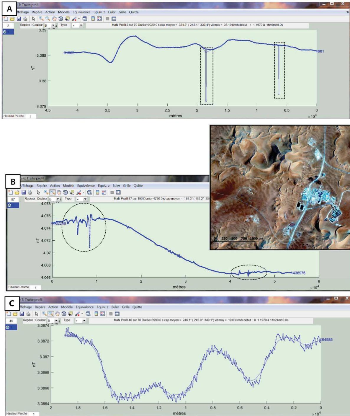
**Figure II-6 :** Exemples de bruits magnétiques le long des profils magnétiques. (A) Pics ; (B) bruit anthropique ; (C) bruit résiduel. La courbe lisse bleue résulte du calcul des données du profil par interpolation à partir de la grille.
