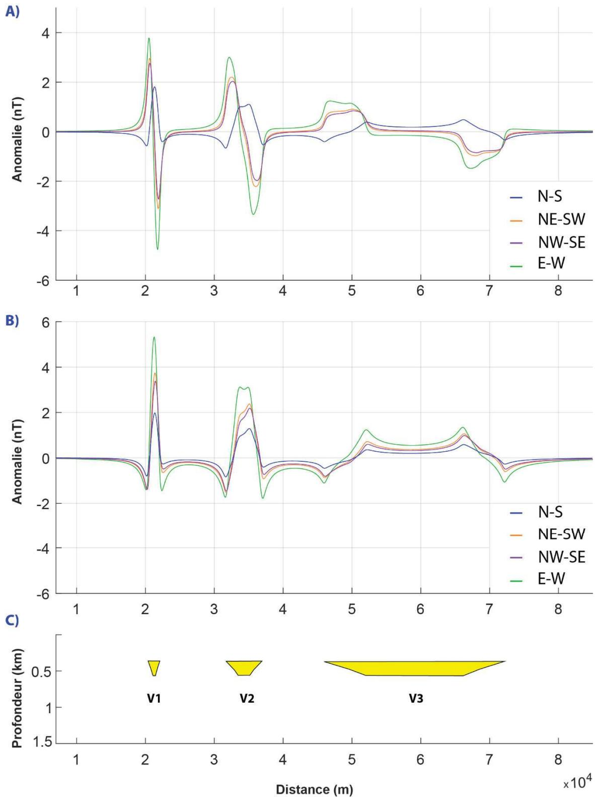
**Figure V-12 :** Modélisation magnétique à 2 dimensions de différentes orientations et morphologies de vallées. A) Profils d'anomalies magnétiques correspondant à 4 orientations (EW ; NE-SW ; NW-SE et N-S) des vallées V1, V2 et V3 ; B) Profils magnétiques obtenus après application de la réduction au pôle ; C) Modèles géologiques des vallées V1, V2 et V3.
