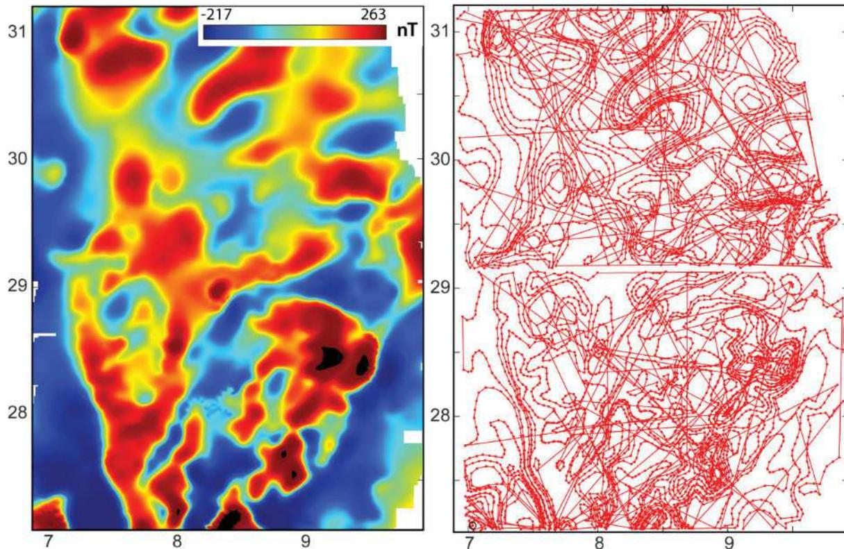
**Figure II-13** : Carte magnétique (à gauche) de la grille de donnée des bassins d'Ilizi-Berkine (*IB32*) et carte des isocourbes d'anomalies digitalisées de la carte en format papier.
