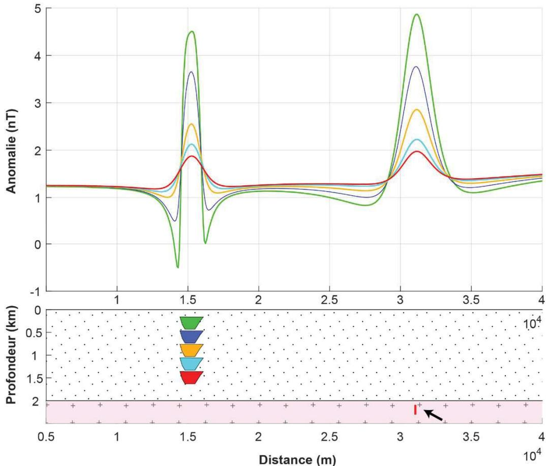
**Figure V-16** : Modélisation à deux dimensions montrant une signature magnétique liée à un approfondissement d'une vallée et l'effet que peut avoir une intrusion de socle (S1) sur la reconnaissance d'une anomalie générée par l'une de ces vallées localisées à : 160 m (verte), 360 m (bleu), 760 m (orange), 1060 m (cyan), 1360 m (rouge).
