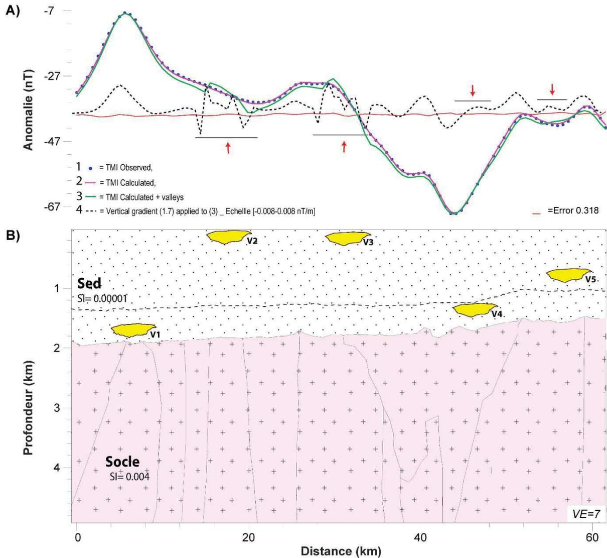
**Figure V-20 :** Modèle magnétique 2D calculé sur la base de la ligne sismique 1. A) Anomalies observées (points bleus) et calculées avec (ligne verte) ou sans (ligne rose) l'ajout des vallées (vert) ; B) Modèle géologique obtenu montrant l'hétérogénéité de socle ; la vallée V4 est réelle (cf. Fig. V-19) tandis que les vallées V1, V2, V3 et V5 ont été « artificiellement » surimposées à la stratigraphie régionale.
