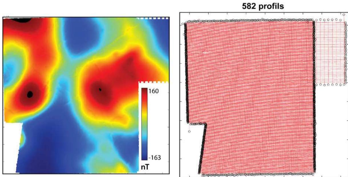
**Figure II-15 :** Carte et lignes de vol aéromagnétiques de la zone centrale du Viking Graben
