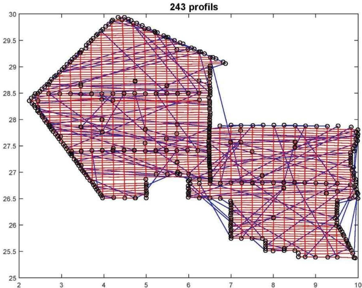
**Figure II-3** : Plan de vol du levé aéromagnétique AM321. Les lignes rouges représentent les profils E-W et les traverses N-S ; les petits cercles noirs représentent les marqueurs de début et fin des lignes de vol.
