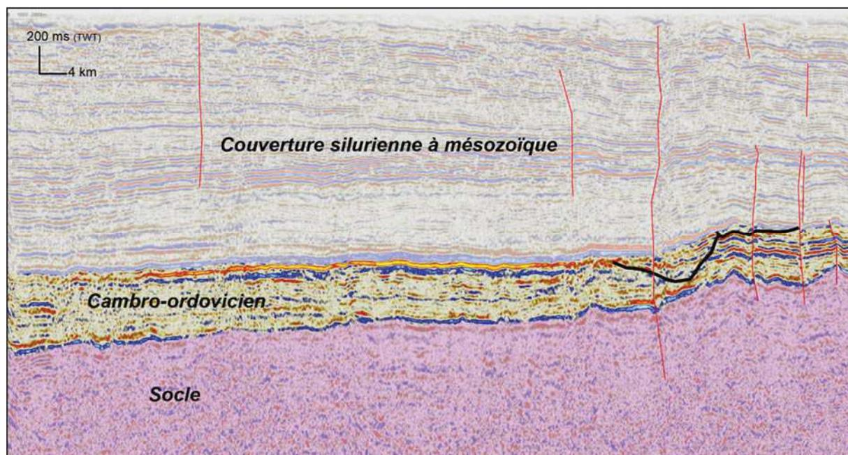
**Figure V-19 :** Ligne sismique 2D localisant le toit du socle, toit du cambro-ordovicien, des rejets de failles dans le socle et deux paléovallées ordoviciennes. Cette section sert de base pour le modèle de la figure V-20 (voir localisation dans la figure V-22).
