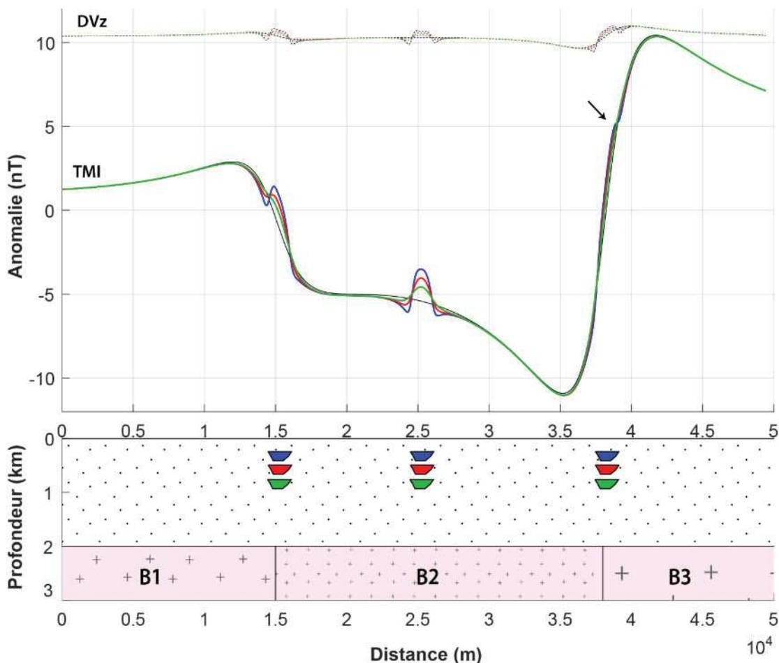
**Figure V-17** : Modélisation à deux dimensions montrant l'effet des hétérogénéités de socle (B1, B2 et B3) sur la caractérisation magnétique d'une vallée. Les courbes en trait continu (au centre) indiquent les anomalies calculées pour les différentes profondeurs de vallées : 260 m (bleu), 740 m (rouge), 760 m (vert). Les courbes en trait discontinu (en haut) représentent les dérivées verticales correspondantes.
