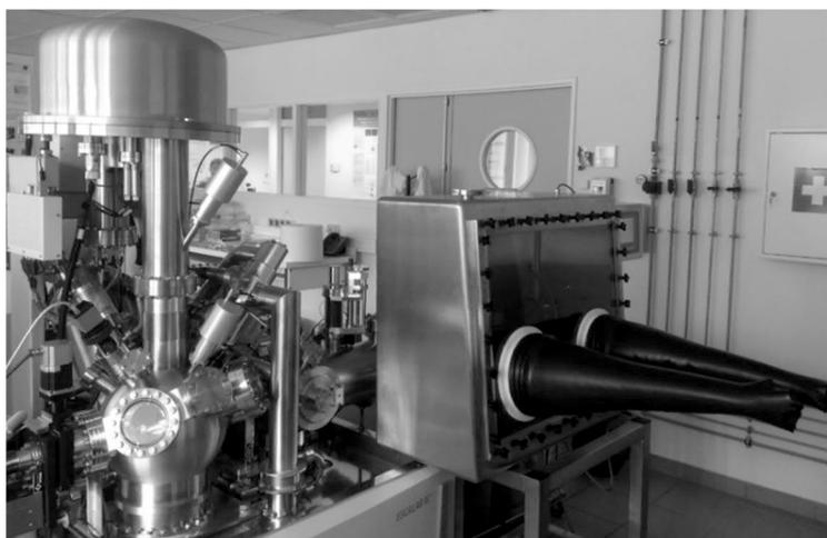
**Figure 2-10 : Spectromètre XPS Escalab 250 Xi de Thermo-Fisher avec sa boîte à gants connectée**
