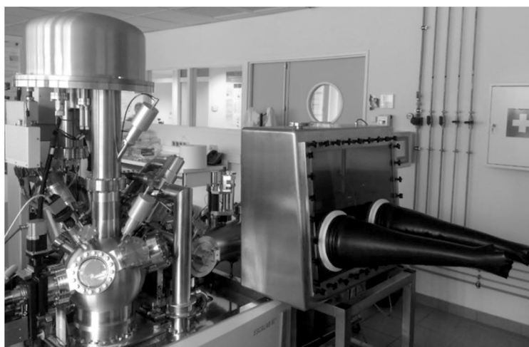
Figure 2-10 : Spectromètre XPS Escalab 250 Xi de Thermo-Fisher avec sa boîte à gants connectée
