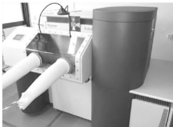
Figure 2-9 : Spectromètre XPS K-alpha de Thermo-Fisher avec sa boîte à gants connectée
